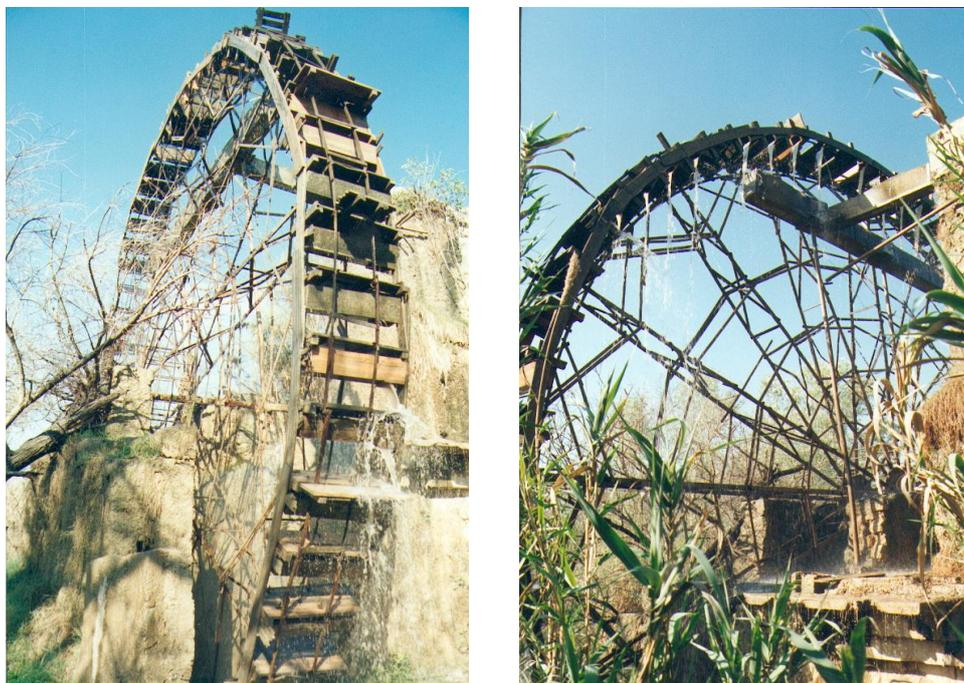
Fig. 21. La noria conservada junto a la lucentina aldea de Jauja emplea el sistema de cangilones de madera situados junto a cada uno de los álabes.
