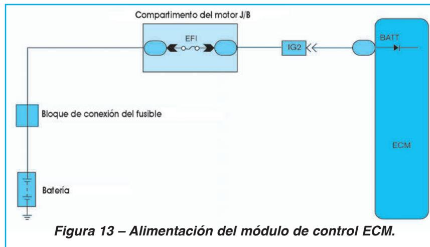
Figura 13 – Alimentación del módulo de control ECM.
