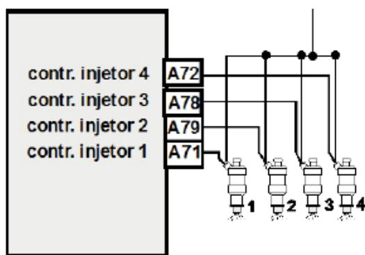
En la figura 27 se puede apreciar un diagrama eléctrico de un ECM, para el control de los inyectores. Dentro del circuito para simular los actuadores básicamente lo que se hace es tener un relevador, aplicado permanentemente a 12V y los otros extremos colocados al control desde el ECM, que en su mayoría es por masa, como lo representa el diagrama superior.
