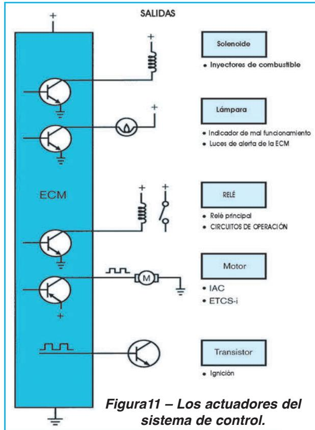
Figura 11 – Los actuadores del sistema de control.
