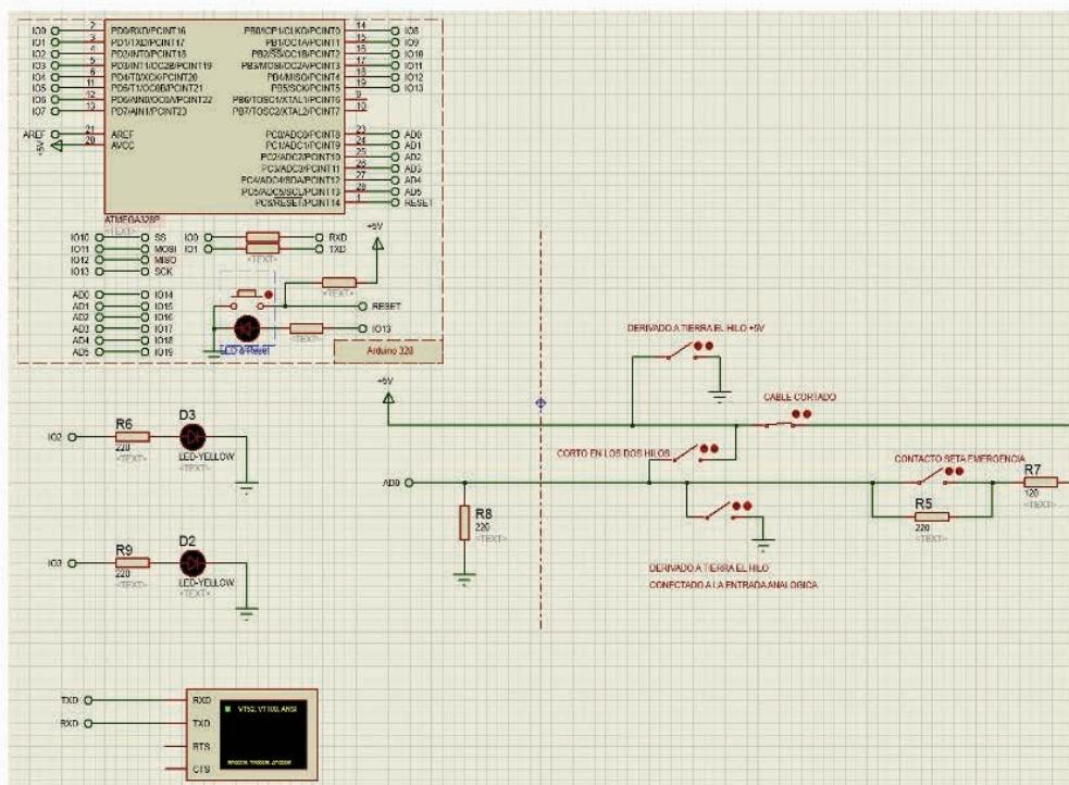
Básicamente, hemos utilizado dos entradas digitales IO2 e IO3 para manejar dos leds. De esta manera uno de ellos (D1) lo utilizaremos para mostrar la salida con la que controlamos nuestra puerta (luce cuando ordenamos detenerse a la puerta) y el otro (D2) lo utilizaremos para indicar que tenemos un problema en el cable (luce cuando el cable está mal y se apaga cuando el cable está en condiciones correctas).
