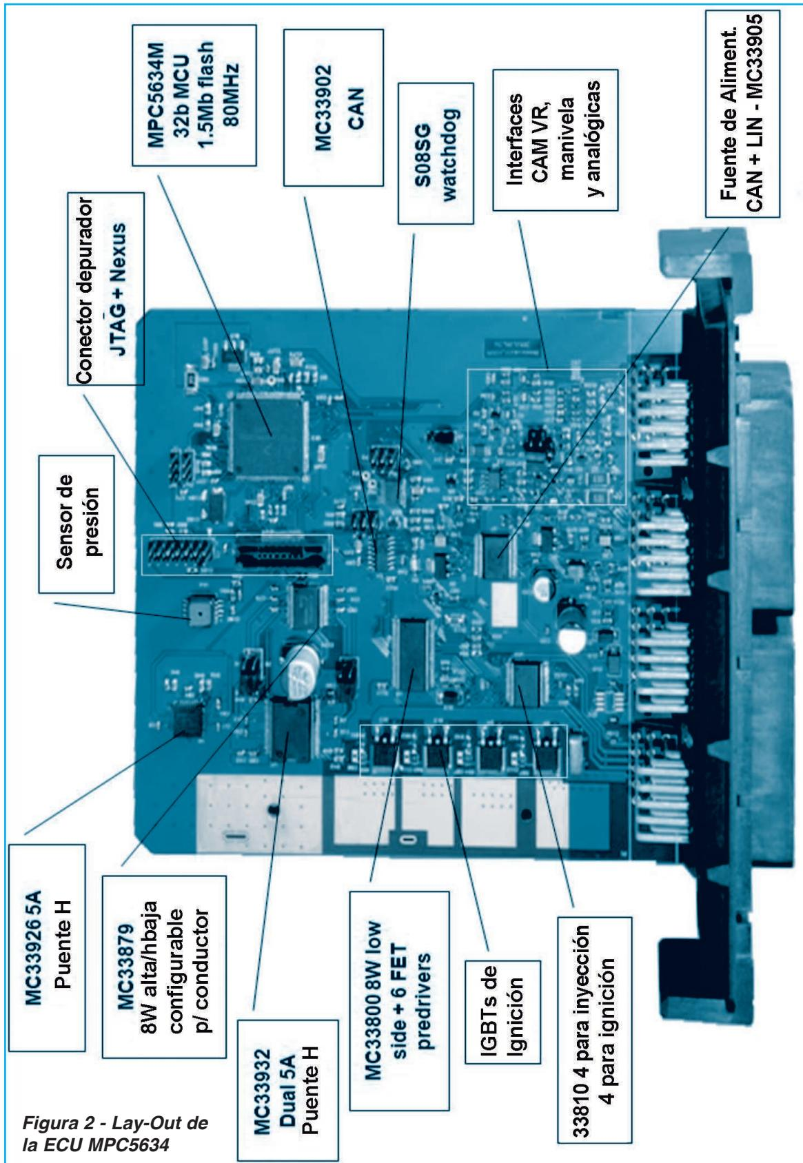
Figura 2 - Lay-Out de la ECU MPC5634
