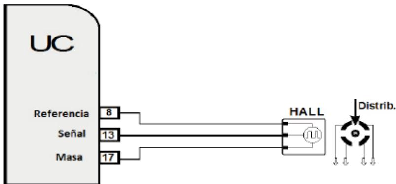
Para este caso en el cable correspondiente a señal se va utilizar un circuito electrónico fabricado de forma muy sencilla que permitirá generar pulsos, siempre es necesario conocer cómo funciona cada uno de los circuitos del ECM, porque pueden ser pulsos a positivos o a negativo, el circuito que se muestra a continuación permite probar ambos circuitos sin riesgo, pero en el caso de el ejemplo la señal debe ser pulsada a masa puesto que el ECM cuenta con una resistencia colocada a positivo.
