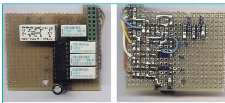
Figura 5 - Vista de la placa de circuito impreso universal sobre la que se monta la etapa de entrada.
