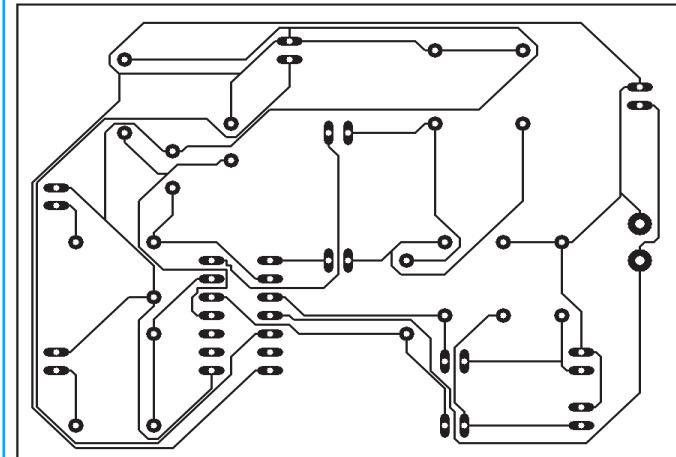
Figura 2 - Placa de circuito impreso para montar el control automático de ganancia.
