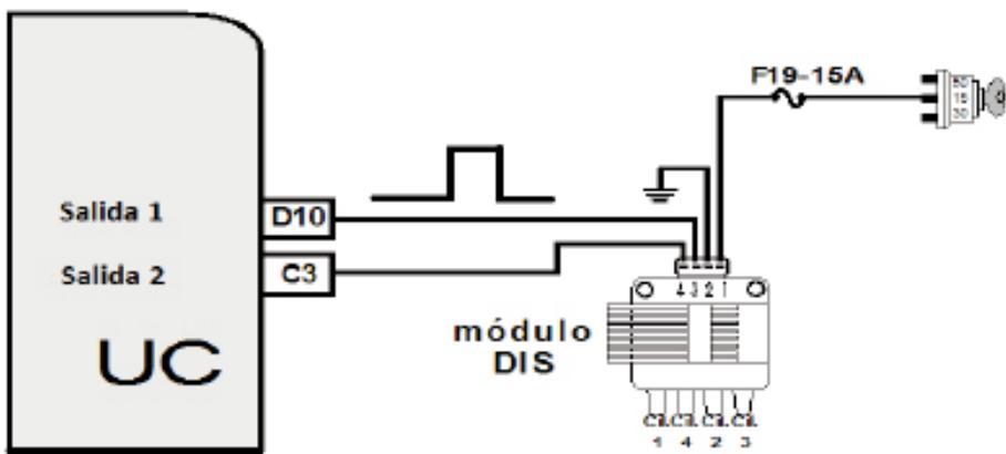
Para poder emular esa salida y poder evaluarla, se van a utilizar un par de diodos emisores de luz LEDS, con una respectiva resistencia para este fin, esta serie de pulsos en su gran mayoría son a positivo y cercanos a 5V, en el circuito de la figura 23 se muestra un arreglo electrónico para lograr la correcta prueba.
