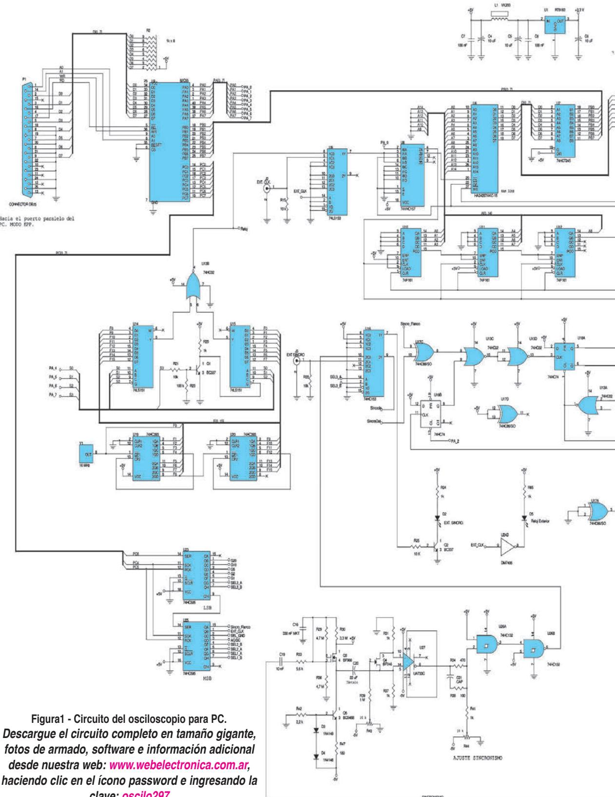
**Figura1 - Circuito del osciloscopio para PC.**
