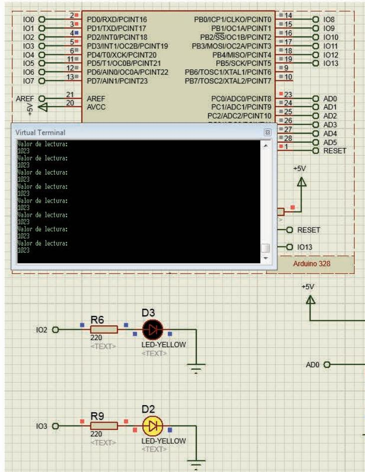
Por último queremos destacar el caso de que el hilo que lleva los +5V se derive a tierra. Observe que Proteus nos permite seguir la simulación. En realidad, en la vida real estaríamos cortocircuitando la fuente de +5V que alimenta nuestro Arduino y el equipo se apagaría. Por eso es necesario siempre proteger y separar la alimentación de las entradas que salen al campo, pero eso lo dejamos para otro momento. Por ahora, a los efectos de lo que nos ocupa en esta lección nos sirve este esquema.
