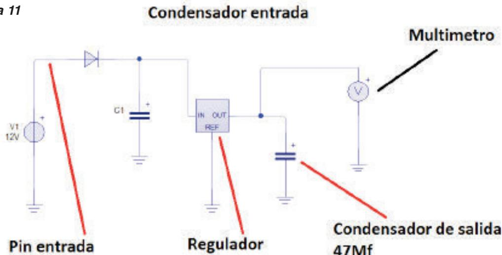
**CONCLUSION.** En la etapa de la fuente una vez se realice la medición el resultado debe ser 5V, en el condensador de salida, se recomienda instalar la fuente, observando los pines del esquema eléctrico del vehículo según el manual, y dentro del ECM las mediciones de acuerdo al Datasheet del integrado del regulador.
