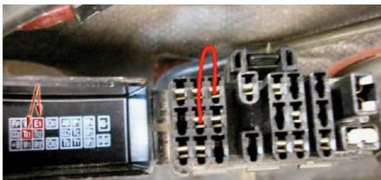
Para el tipo DLC 1 en el compartimiento del motor conecte los terminales TE1 y E1. Use como guía la información de referencia con la ubicación de los terminales que se encuentra debajo de la tapa (figura 7). Busque DLC 3, debajo del tablero de instrumentos conecte los terminales 13 (TC) y 4 (CG)
