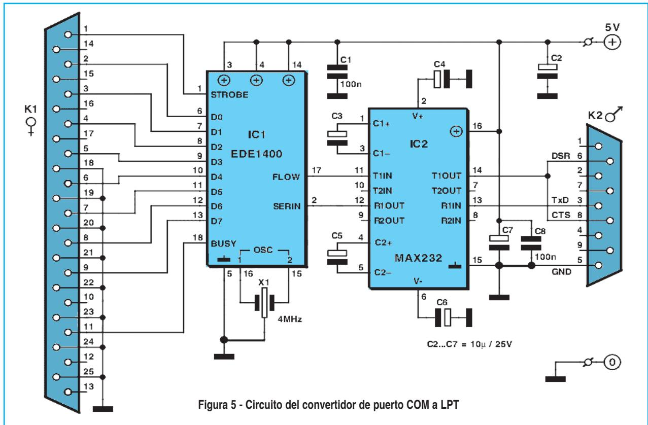
Figura 5 - Circuito del convertidor de puerto COM a LPT
