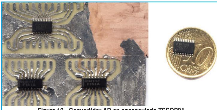
Figura 10 - Convertidor AD en encapsulado TSSOP24.
