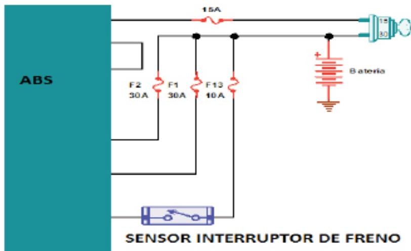
Para emular la señal solo es necesario utilizar un interruptor tipo pulsador, de acuerdo al esquema se puede utilizar el interruptor a positivo a negativo, y utilizando una resistencia de  $100\Omega$  en serie, para reducir la corriente en el circuito, pensando en algún error al momento de la conexión en el ECM, en el circuito de la figura 17 se puede apreciar el esquema de montaje para este emulador.
