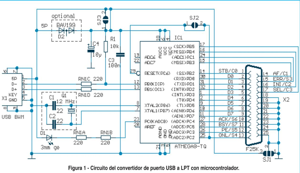
Figura 1 - Circuito del convertidor de puerto USB a LPT con microcontrolador.
