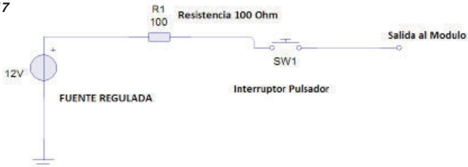
cuado para el posterior montaje en un gabinete de proyectos, donde se acoplarán todos los elementos, en la figura 18 se puede apreciar este elemento, para el caso de la resistencia la potencia es de  $\frac{1}{2}$  Watt.
