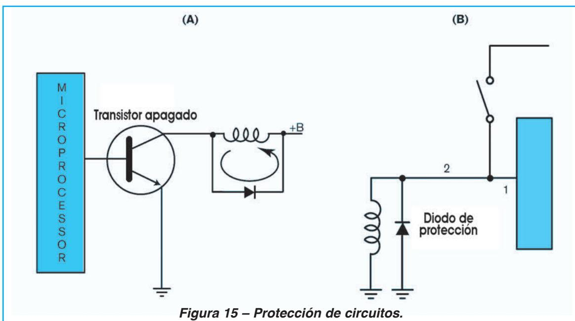
Figura 15 – Protección de circuitos.
