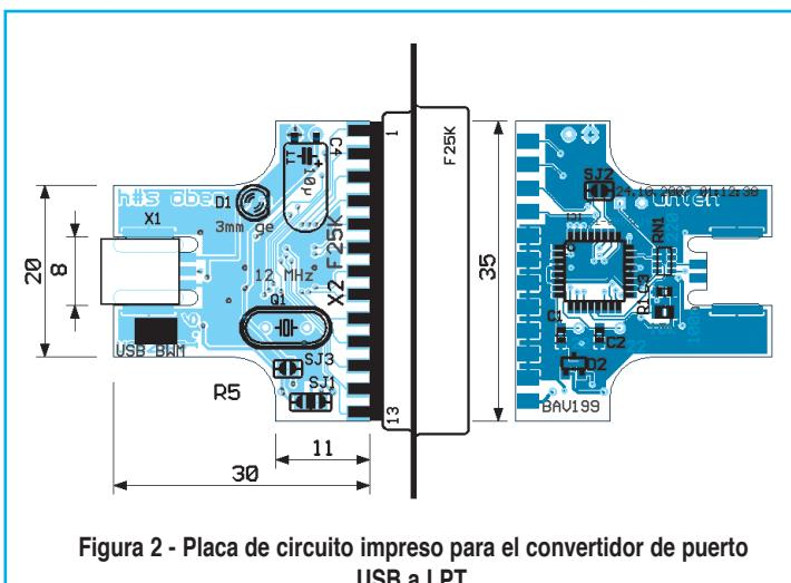
Figura 2 - Placa de circuito impreso para el convertidor de puerto USB a LPT.
