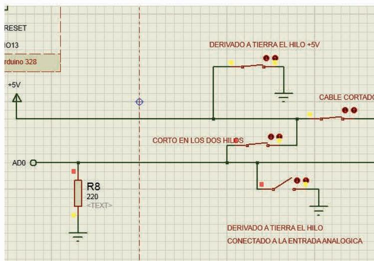
De esta manera terminamos con la utilización de las entradas analógicas para implementar entradas digitales con vigilancia de cable.
