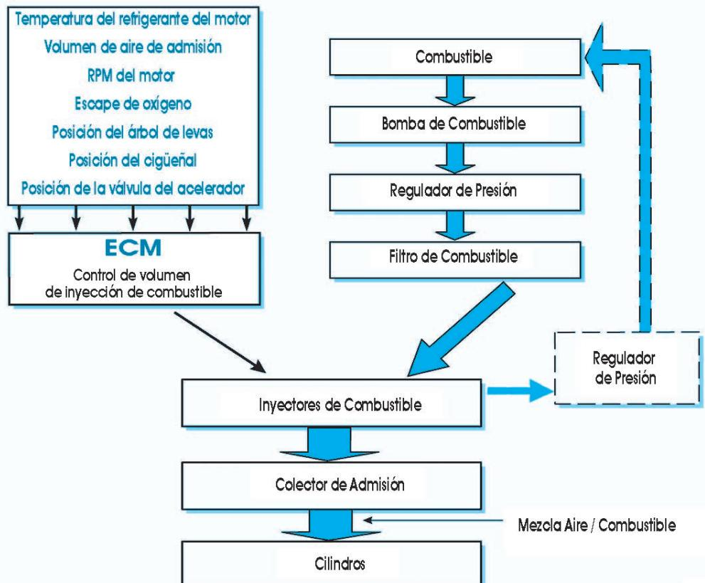
**Figura 4 – Sistema de inyección de combustible.**
