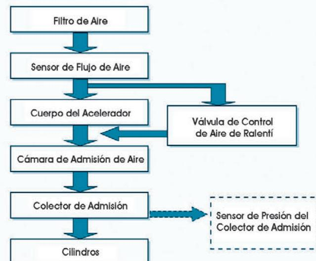
*Figura 3 - Sistema de inducción de aire.*
