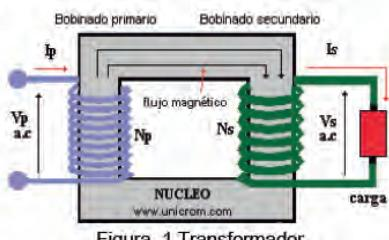
Figura 1 Transformador
