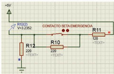
Además hemos añadido, con carácter pedagógico, cuatro contactos para ayudarnos a simular los posibles fallos que se pueden producir en nuestro cable. Una derivación a tierra del hilo conectado a +5V, una derivación a tierra del hilo conectado a la entrada analógica, un cortocircuito entre ambos hilos y la ruptura de uno de los hilos. De esta forma es sencillo comprobar todos los casos posibles y ver como reacciona nuestro circuito.
