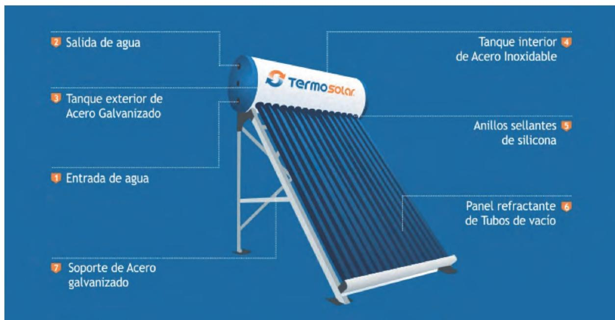
La energía solar transmitida a los tubos de borosilicato calienta el agua que circula por estos y la almacena en un termo tanque, similar a un calefón eléctrico, que en su interior está aislado por 2 pulgadas de poliuretano térmico, manteniendo así la temperatura del
