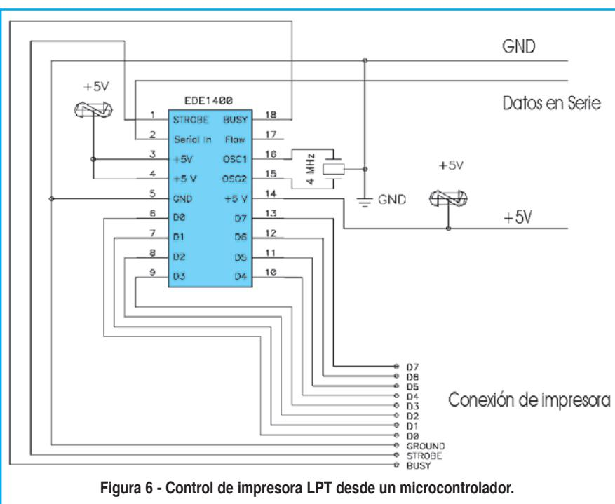
Figura 6 - Control de impresora LPT desde un microcontrolador.
