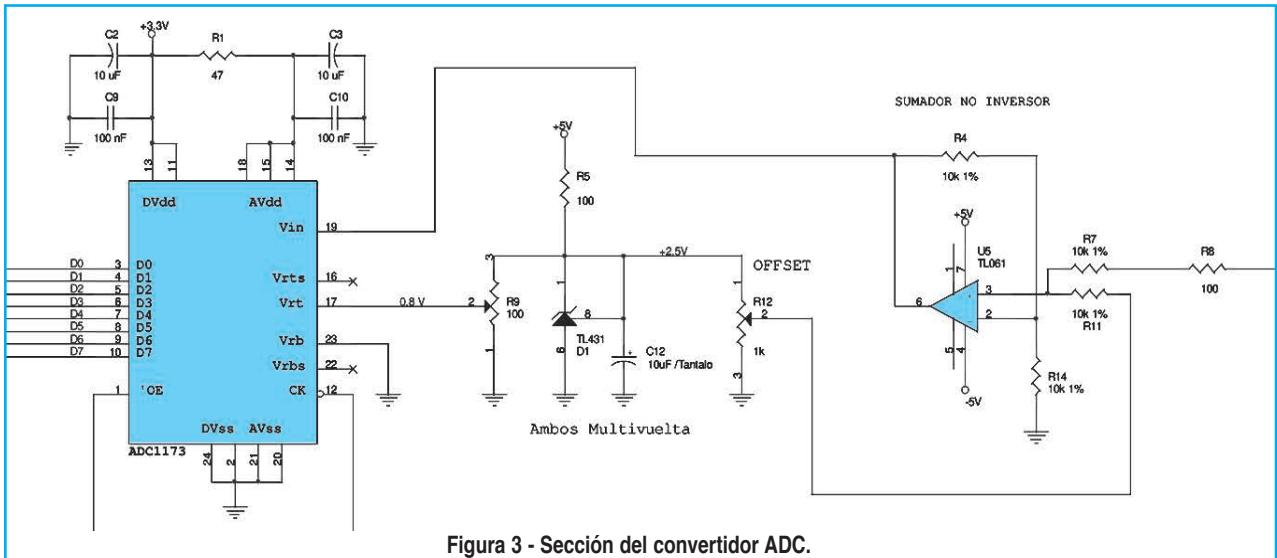
Figura 3 - Sección del convertidor ADC.
