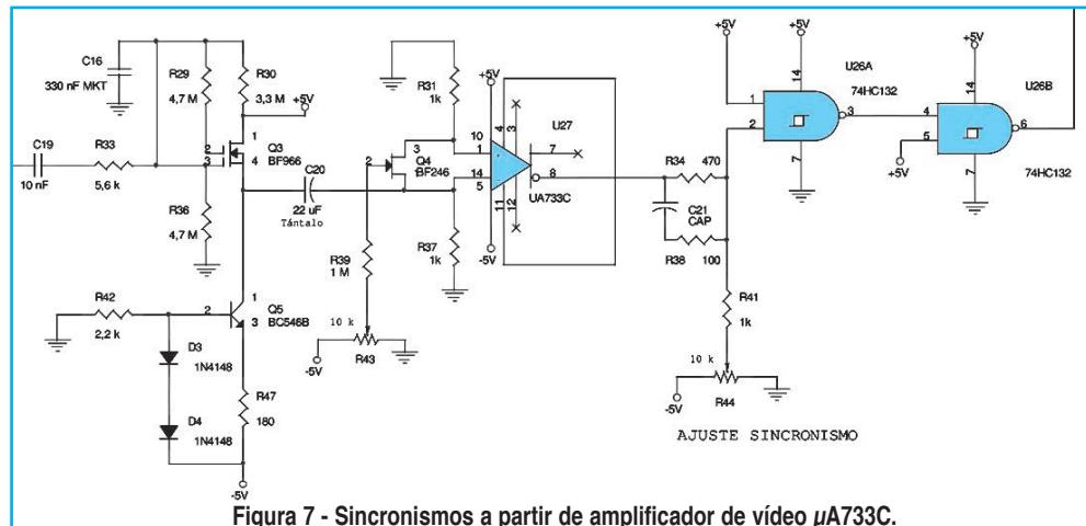
**Figura 7 - Sincronismos a partir de amplificador de vídeo μA733C.**
