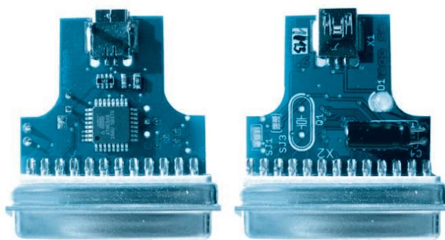
Figura 3 - Detalle de armado del convertidor de puerto USB a LPT
