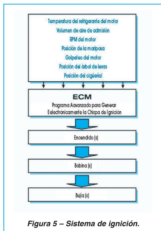
*Figura 5 – Sistema de ignición.*
