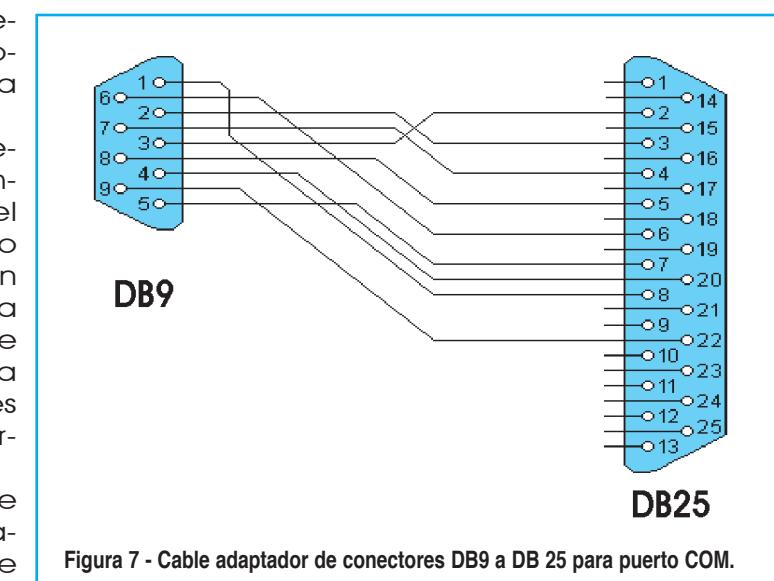
Figura 7 - Cable adaptador de conectores DB9 a DB 25 para puerto COM.
