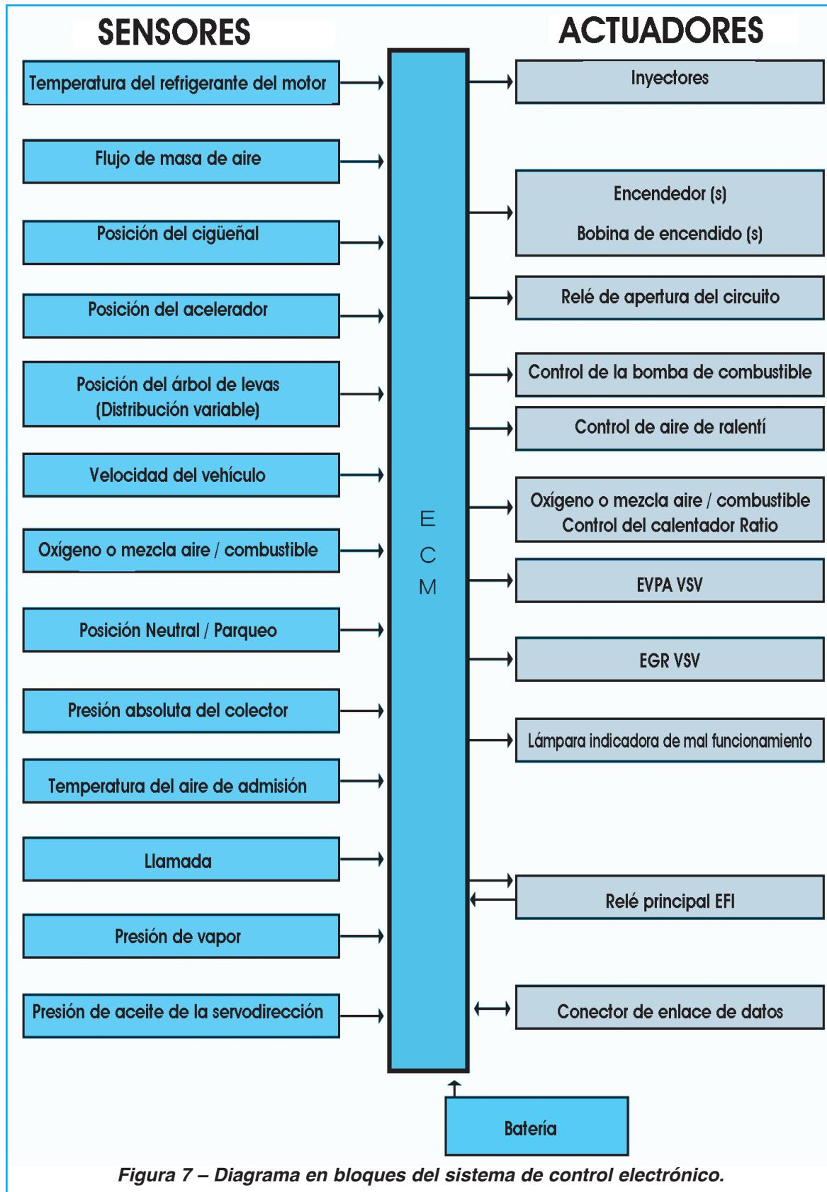
Figura 7 – Diagrama en bloques del sistema de control electrónico.
