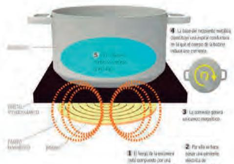
Figura 4 Funcionamiento de la Cocina de Inducción
