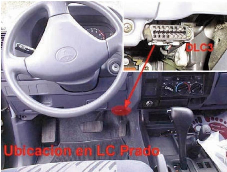
Empleando la herramienta especial No. 09843-18020, que no es mas que un pequeño trozo de cable con tres puntas como se ve en la figura 5 o, en su defecto, un pequeño trozo de cable con dos puntas sin aislante, o cualquier otra cosa que sirva para tal fin, como un clip o un trocito de alambre, conecte los terminales del conector de comprobación como se muestra en la figura 6.
