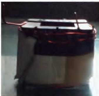
Figura 5 Bobinado primario
