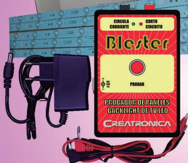
Su salida se ajusta automáticamente para encender desde 1 led hasta más de 60 leds en serie (200 V). Indicadores luminosos: *circula corriente*, *cortocircuito*, y ambos, *circuito abierto*.
