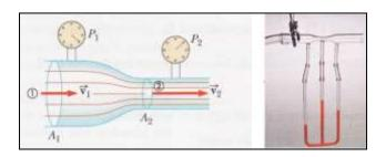
Para determinar la velocidad del fluido en el interior del Medidor de Venturi se utiliza la ecuación:
