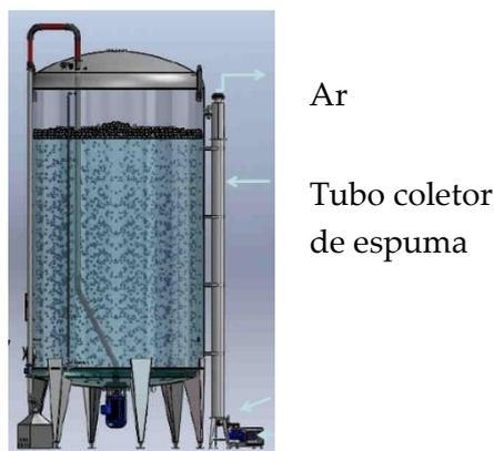
**Figura 2.4**-Esquema de separação de espuma sem centrífuga [41]
