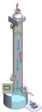
**Figura 2.5**-Representação de um *Air Scrubber* que aumenta a recuperação de etanol e ácido acético perdido por evaporação [41]
