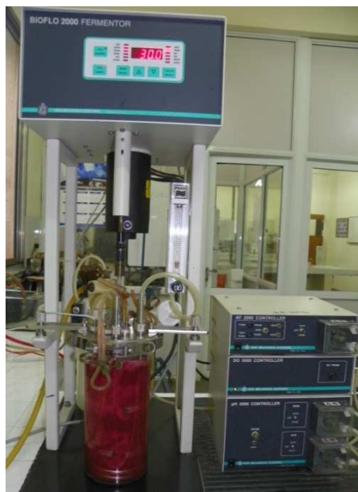
Figura 5.2. Biorreactor New Brünswick Cientific Co., Modelo Bioflo 2000, utilizado en las experiencias de acetificación de sustrato alcohólico de arándanos.
