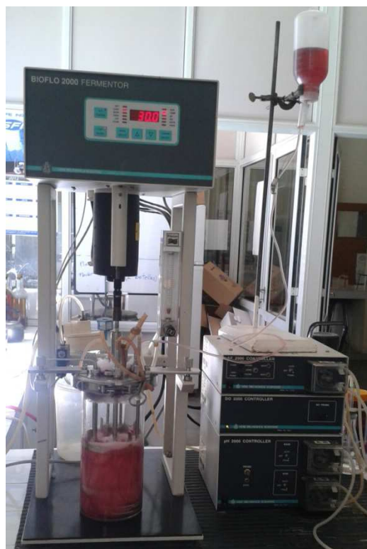
Figura 6.1. Equipo de acetificación de sustrato alcohólico de arándanos en sistema semicontinuo.
