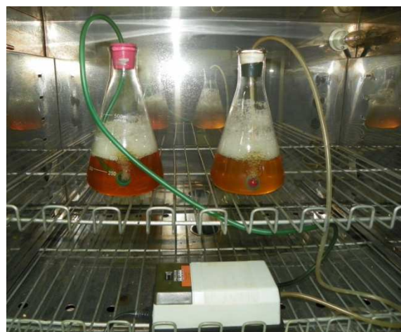
Figura 1.2. Sistema de inyección de aire.
