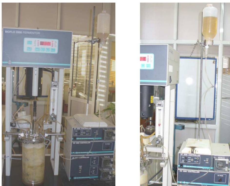
Figura 3.1. Equipo de acetificación en sistema semicontinuo.
