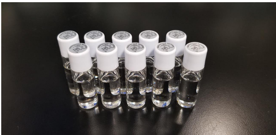
Fig.17. 10 estándares de carbono 14 y 10 estándares de tritio. Ambos quencheados y centellador UG.
