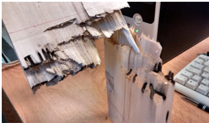
Figuras 32 a 34 – Ataque biológico por taladrillo
