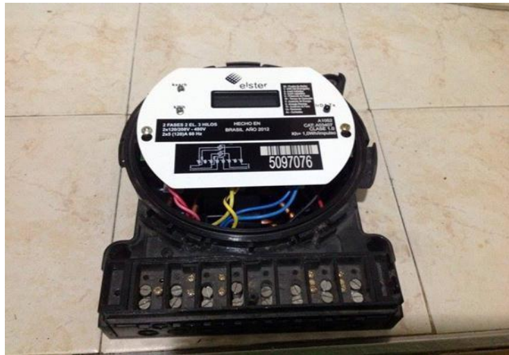
Figura 4. Medidor de energía, tipo estático.
