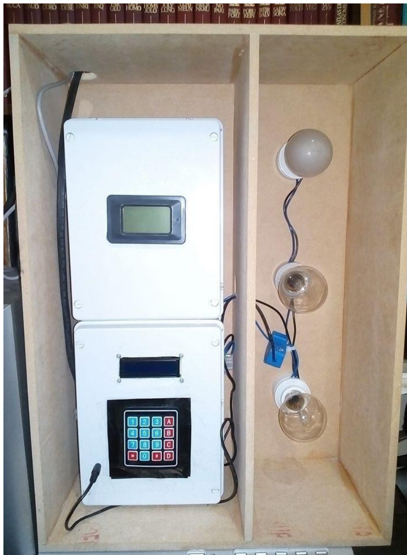
Figura 42. Aspecto final del medidor de energía eléctrica prepago. Fuente: propia.
