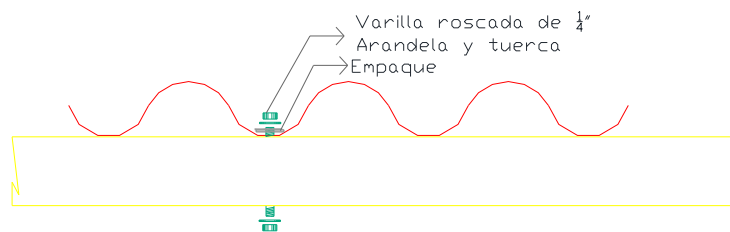
Fig. 21 Anclaje de teja
