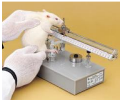
Figura 2. Modo de realización del test de Randall-Selitto.
