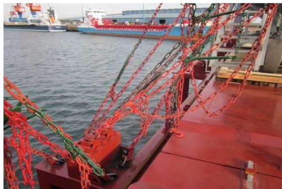
A las 12:15 quedan colocadas las ocho trincas de seguridad y se procede a desengrillar por operarios de ROXU.
