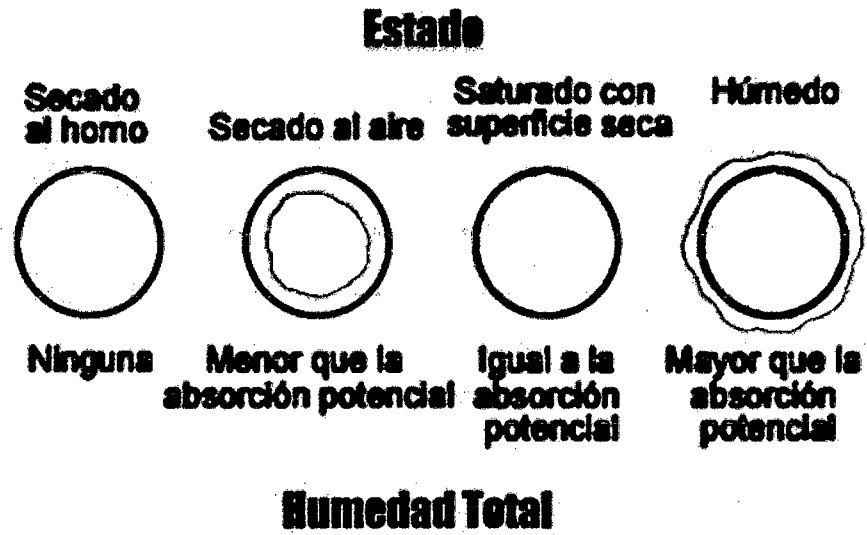
FIGURA 8: ESTADOS DE HUMEDAD DEL AGREGADO Fuente Ing. Enrique Pasquel
