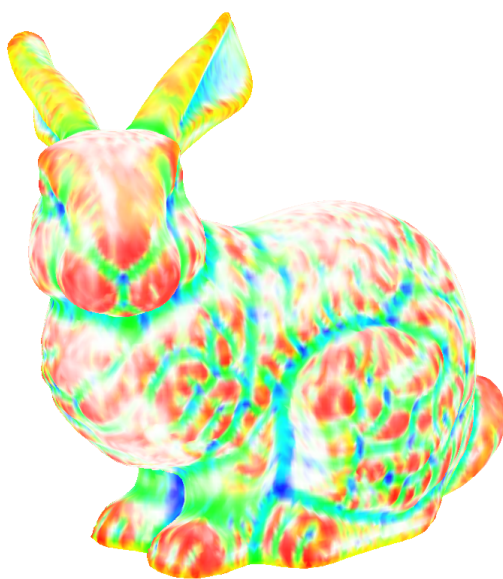
Figura 3.2: Representación gráfica de la estimación de curvatura en el conejo de Stanford. Imagen obtenida utilizando el software RTSC[DFR04], que estima las curvaturas mediante la biblioteca trimesh2 [Rus].
