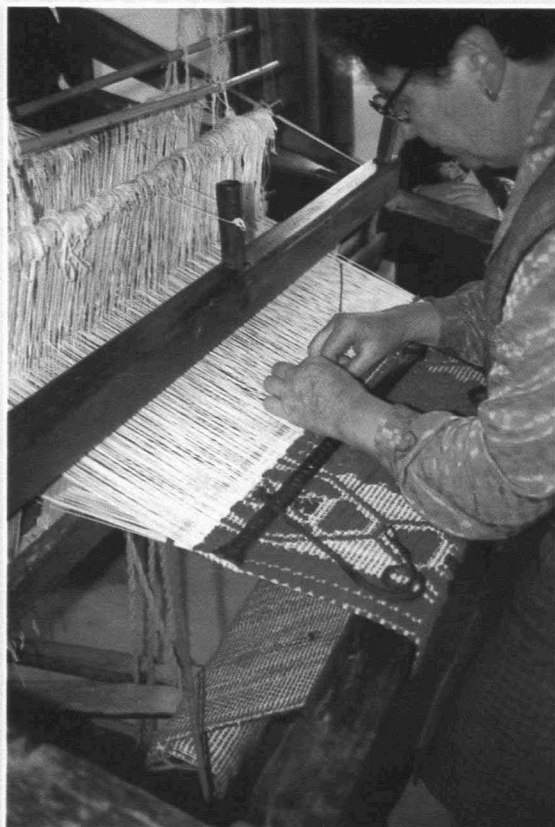
El tempereiro , pieza de hierro graduable para mantener el ancho regular de la tela.
