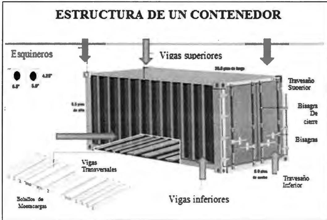
Figura 2: Estructura de un contenedor
