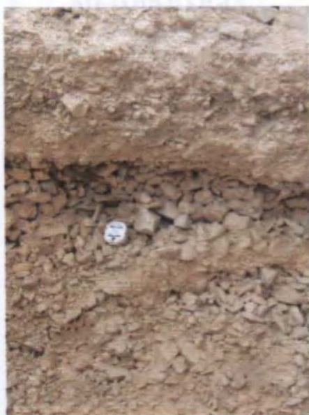
Foto N°6 y 7 En la foto de la izquierda se aprecia el gran espesor del suelo en la parte baja de la manzana "A" y en la derecha el contacto entresuelo y roca medianamente fracturada
