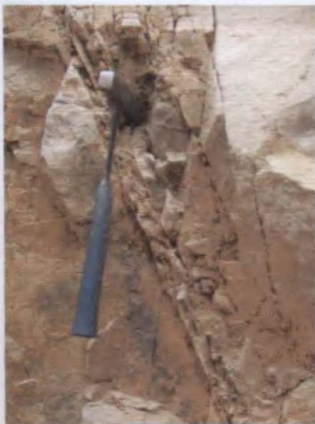
Foto N° 4 y 5. Obsérvese el fracturamiento y alteración de la roca producto de diaclasas y falla local, e incluso la diferencia de colores de la roca en la foto N°5
