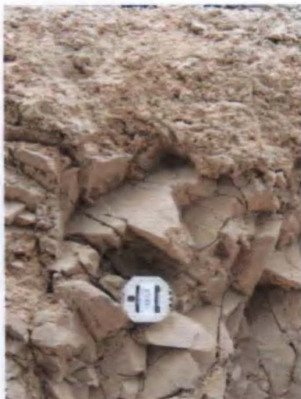
Foto N°6 y 7 En la foto de la izquierda se aprecia el gran espesor del suelo en la parte baja de la manzana "A" y en la derecha el contacto entresuelo y roca medianamente fracturada
