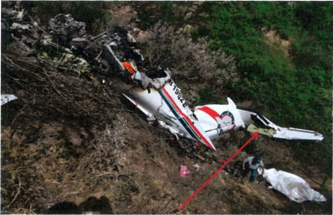
Restos de la cola de la aeronave nótese los daños causados por los dos cables de la red de interconexión eléctrica con los cuales chocaron al momento del viraje
