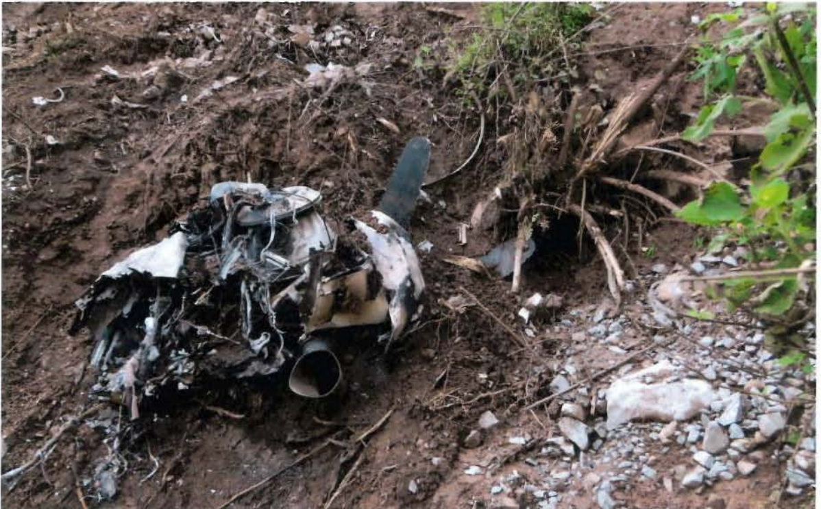
Estado en que quedo el Motor N° 2 después de impactar el terreno con potencia, nótese la ausencia de palas de la hélice que se fracturaron al momento del accidente saliendo despedidas.
