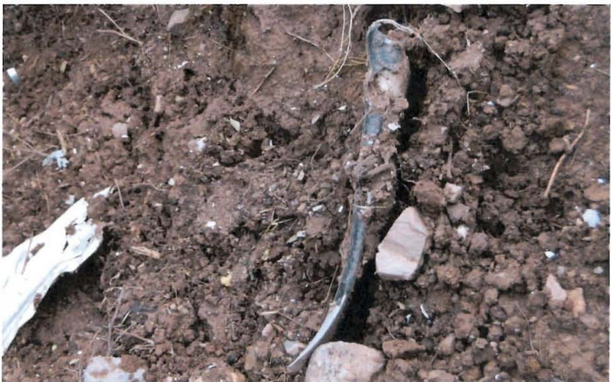
Pala de hélice fracturada en la base al momento del impacto, lo que indica que el motor se encontraba funcionando con potencia
