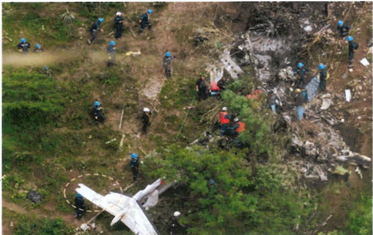
Restos de la aeronave luego de controlar el incendio, nótese los daños causados en el timón de profundidad izquierdo por el impacto con los cables de la línea interconectada.
