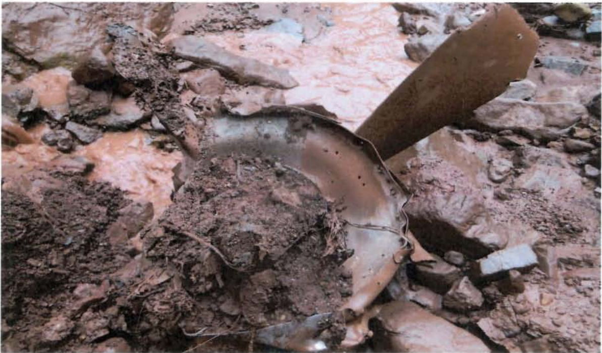
Estado en que quedo la hélice del motor N° 01 que tras el impacto salió despedida al fondo de la quebrada, nótese la ausencia de palas que se fracturaron al impactar el motor con potencia contra el terreno
