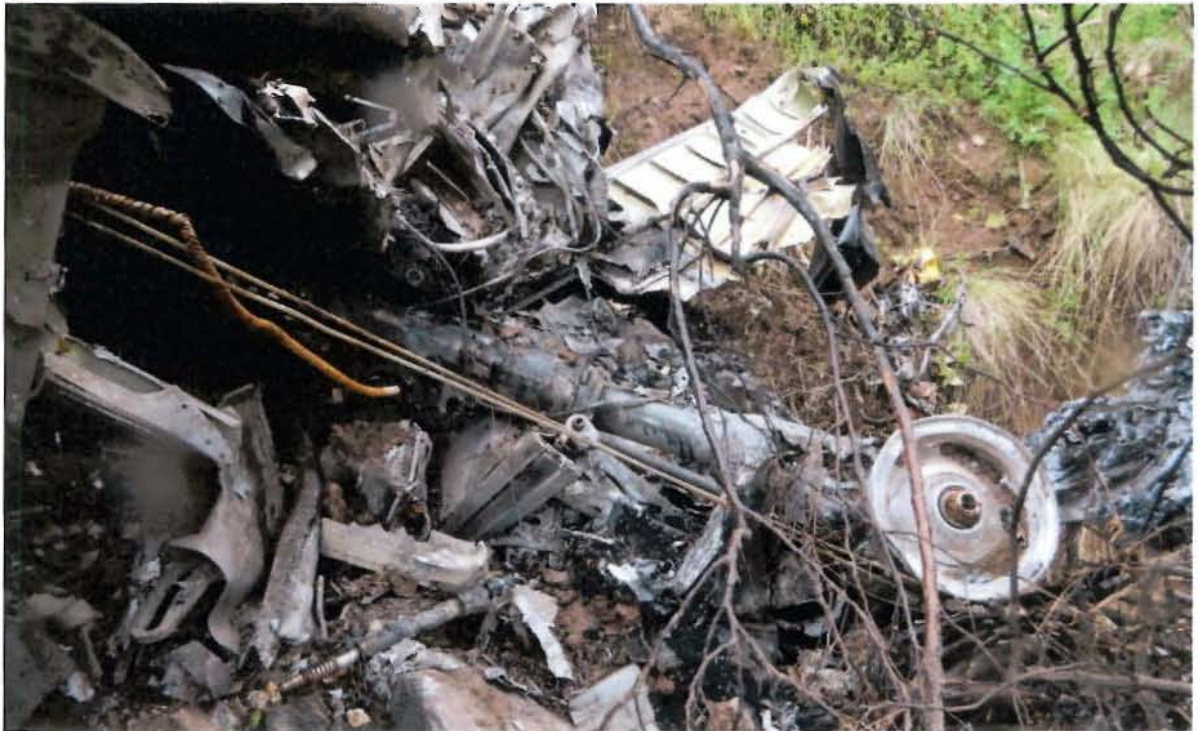
Estado en que quedo el tren principal derecho encontrado en la posición de abajo y asegurado y que fue afectado por el incendio post accidente.
