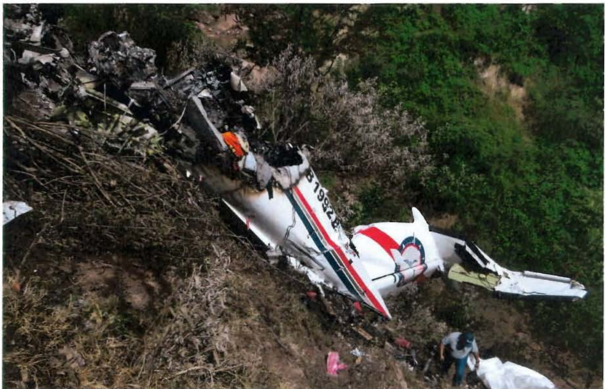
Estado en que quedo la cola después del incendio post accidente del fuselaje y alas del avión
