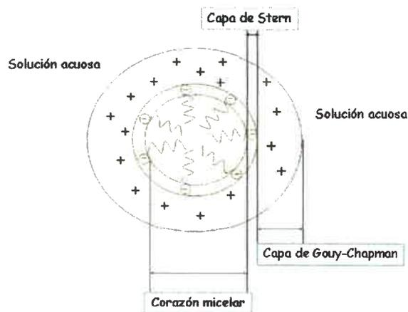
Figura I.5: Estructura completa de una micela directa [13].
