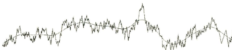
Figura 52. Denominaciones de un perfil representando una superficie ampliada con su rugosidad. (Mitutoyo).
