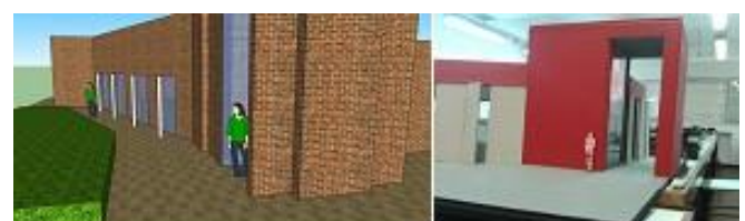
Fig.4 El alumno manipula de manera incorrecta los planos de la propuesta, no otorga los espesores adecuados (losas), no aplica correctamente los materiales (material ladrillo visto a todas las caras de los planos; césped a todas las caras del cantero) y no logra resolver las uniones entre
