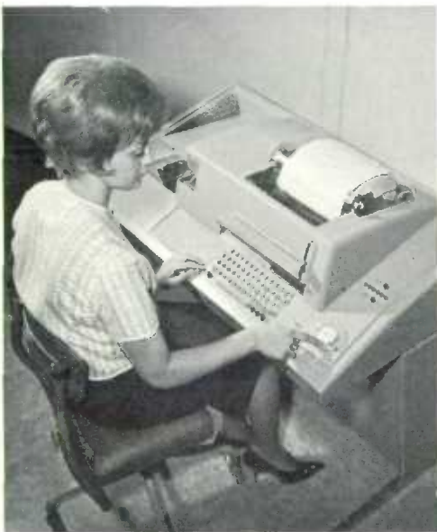
Este nuevo teletipo es capaz de transmitir 100 palabras por minuto. Un disco incorporado permite transmitir las comunicaciones impresas a la red telefónica urbana e interurbana, a voluntad de la operadora.
