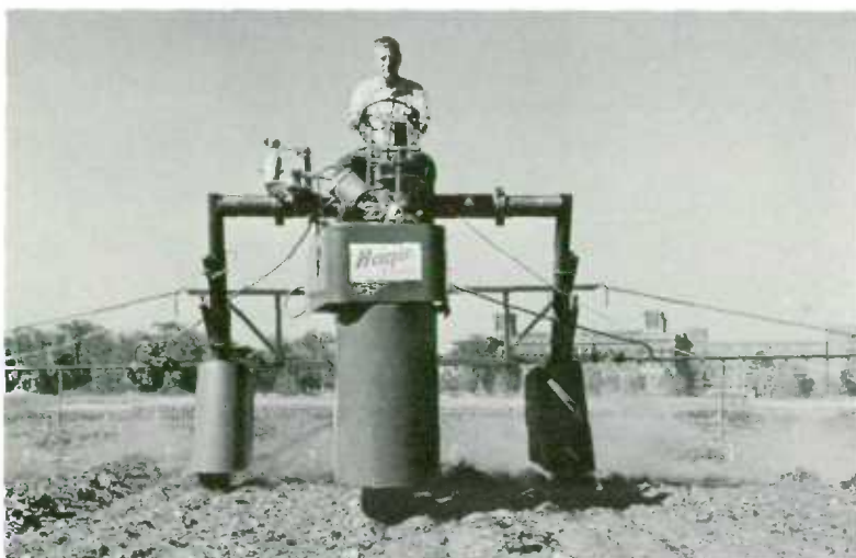
Una rociadora automática que puede levantarse a seis pies de altura para maíz o bajada a seis pulgadas para fresas.
