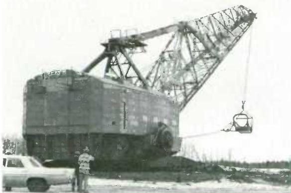
La central termoeléctrica de Wabamun, Alberta utiliza carbón extraído en las cercanías. Esta gigantesca pala mecánica puede desgarrar 35 yardas de carbón de un solo golpe.
