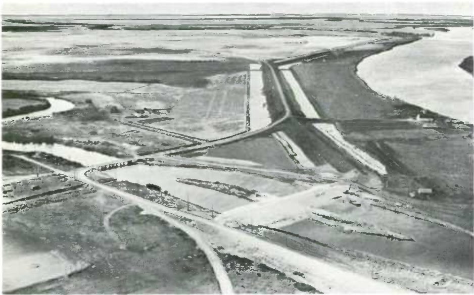
El proyecto de colonización agrícola Pasquia cerca de The Pas, Manitoba es una empresa única federal provincial en la recuperación de tierras. La construcción de presas, 57 millas de diques, 69 millas de desagües y 126 millas de correteras han recuperado para la agricultura 130.000 acres de tierra inundada.
