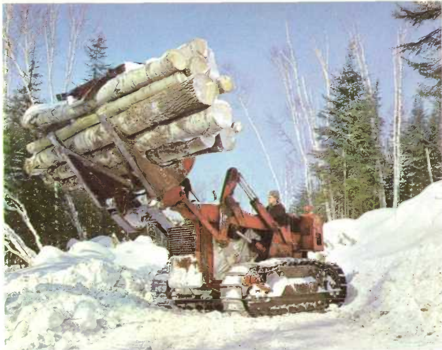
Una cargadora levanta los troncos de la zona de derribo sin necesidad de utilizar carreteras y los transfiere a las carreteras principales de arrastre. Esta carga esta compuesta de troncos de álamo.
