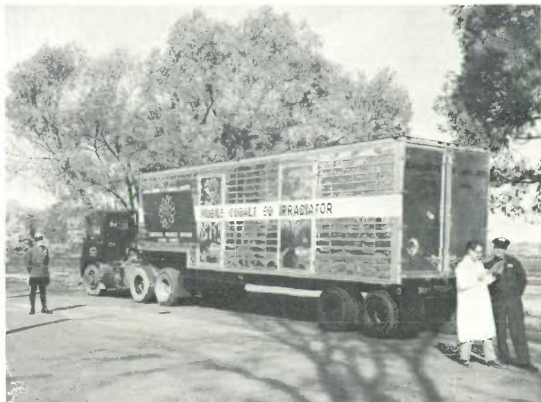
Esta Unidad móvil de irradiador de cobalto 60 se usa para tratar varios alimentos con rayos gama para aumentar su conservación. Ha sido utilizado en varios lugares en el este de Canadá para prevenir la germinación de las papas.
