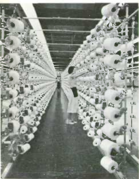
La industria textil ha jugado un papel muy importante en Quebec por muchos años. Aquí vemos las fibras textiles transformándose en hilo.
