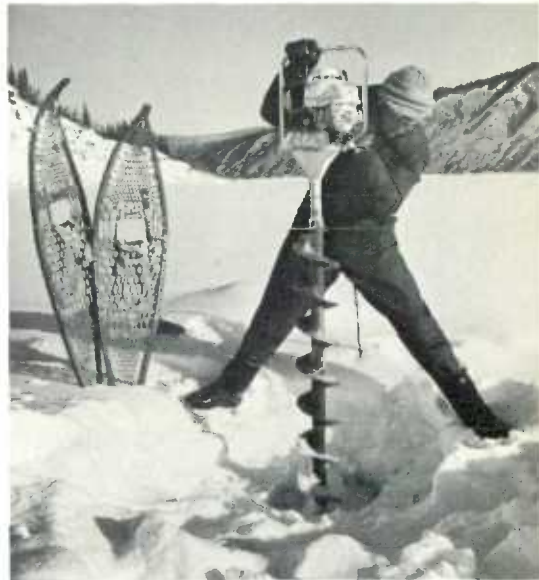
Perforando el hielo del río Yukon para conseguir una corriente de agua, por medio de una perforadora mecánica.
