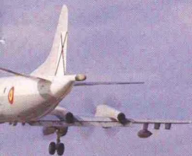
de fijar, con toda precisión, la «firma» de cualquier submarino) los P-3, parando dos de sus cuatro motores, efectúan largos vuelos de tránsito, para permanecer luego seis u ocho horas en las áreas donde patrullan.
