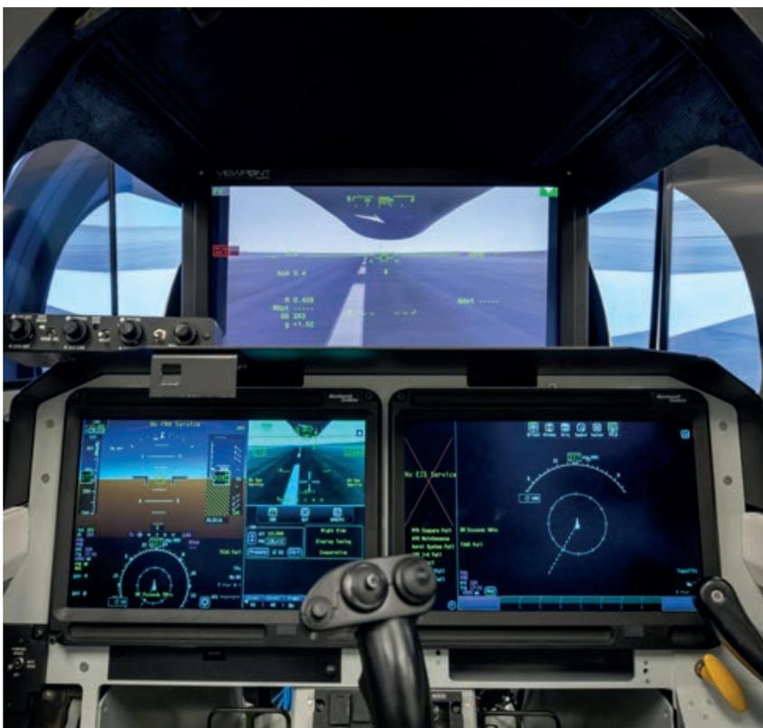
Distribución de las pantallas de la cabina de vuelo del X-59. (Imagen: NASA)
