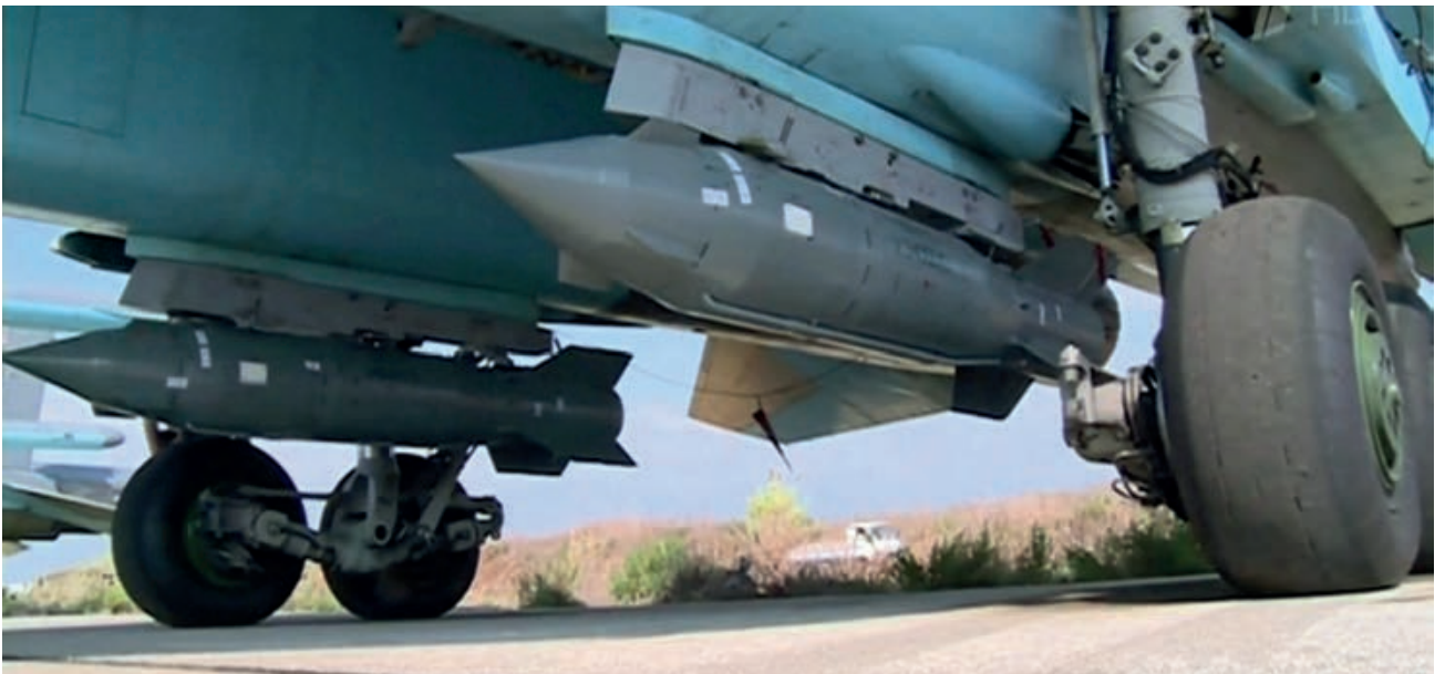
Primer plano de las bombas guiadas por GPS KAB-500S, cargadas en un Su-34
