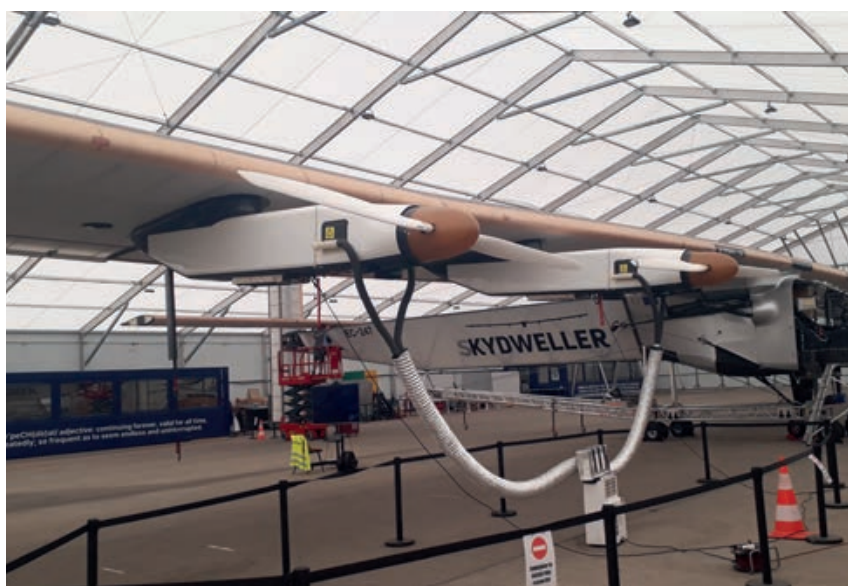
Detalles de los cuatro motores eléctricos que impulsan esta aeronave
