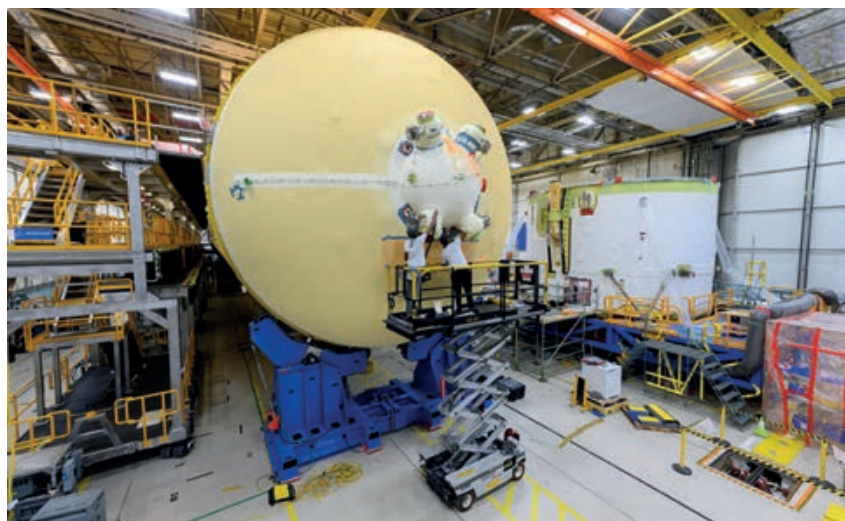
La sección del motor es la última estructura importante que constituye la etapa central del cohete del Sistema de Lanzamiento Espacial de la NASA que ayudará a impulsar la misión Artemis II. (Imagen: NASA)
