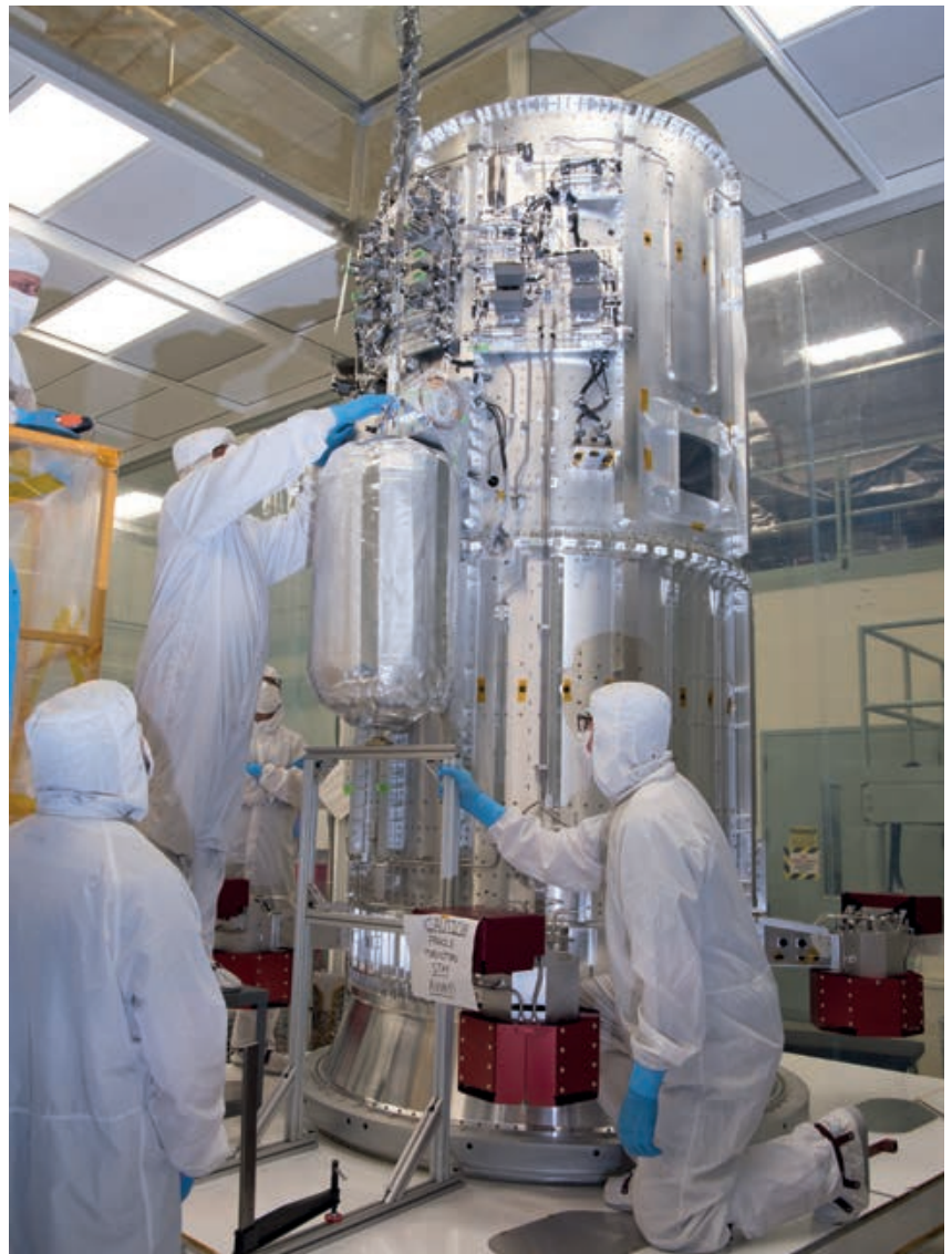
Técnicos trabajando en el sistema de propulsión de la sonda Europa Clipper. (Imagen: NASA/GSFC/Barbara Lambert)
