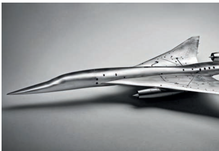
Maqueta del Aerion AS2 ensayada en túnel aerodinámico en Modane. (Imagen: Aerion Supersonic)
