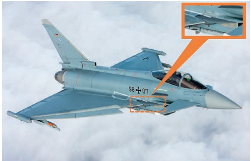
IPA7 con el AMK instalado. (Imagen: Eurofighter-Andreas Flying Wings)
