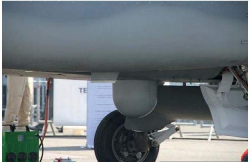
A la izquierda, el radar I-MASTER. A la derecha, su ubicación en el Textron Scorpion durante el Paris Air Show de 2015. (Imagen de la izquierda, copyright Thales. Imagen de la derecha, copyright Air Recognition)
