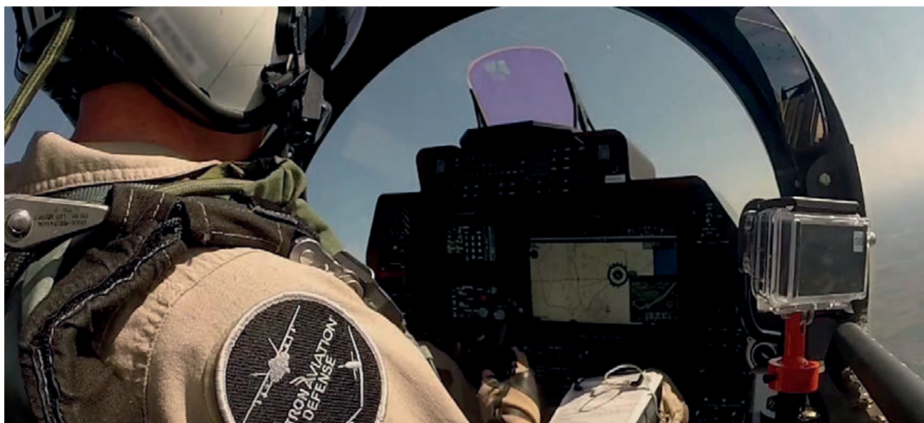
El cockpit del Scorpion (asiento del piloto), en el que puede verse además del LiteHUD, la gran superficie de la pantalla WXGA de 14.1 pulgadas. (Imagen: Textron)
