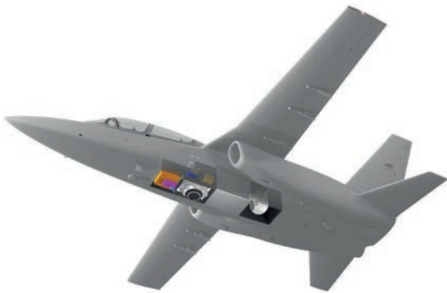
Imagen conceptual en la que se muestra la localización de las tres bahías internas. (Imagen: Textron)
