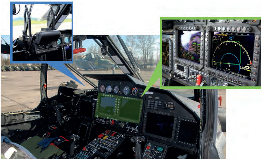
Cockpit del Ka-52, en el que se muestra tanto el HUD ILS-31 (desmontado en la imagen principal) y la información presentada en las pantallas centrales. (Imágenes de Fedor Leukhin)
