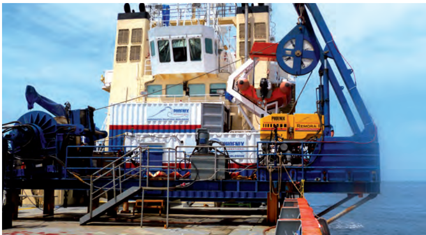
Plataforma de lanzamiento del ROV. A la izquierda de la imagen aparece el winche o cabrestante con el cordón umbilical.
