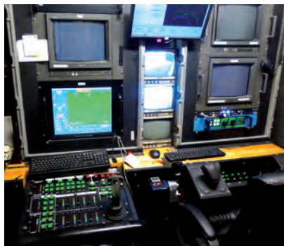
Centro de pilotaje del ROV. A la izquierda el "joystick" de mando, a la derecha los mandos de los brazos mecánicos y en el centro las pantallas de posición, imágenes y sonar.
