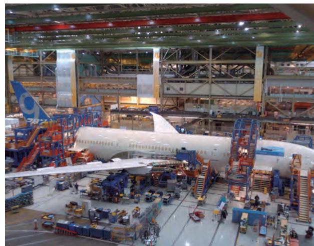
El primer 787-9 en montaje en Everett.. El "9" pintado en la deriva es el indicativo de la versión a que pertenece. -Boeing-
