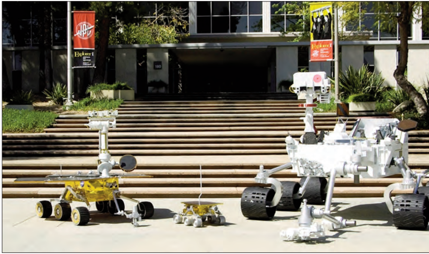
Comparativa entre los robots MER, Sojourner y MSL.
