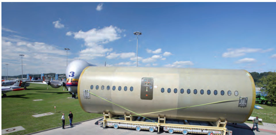
Airbus completó en julio la construcción de un segundo segmento de fuselaje del A350 para experimentación y certificación conocido como "Barrel 1B". -Airbus-
