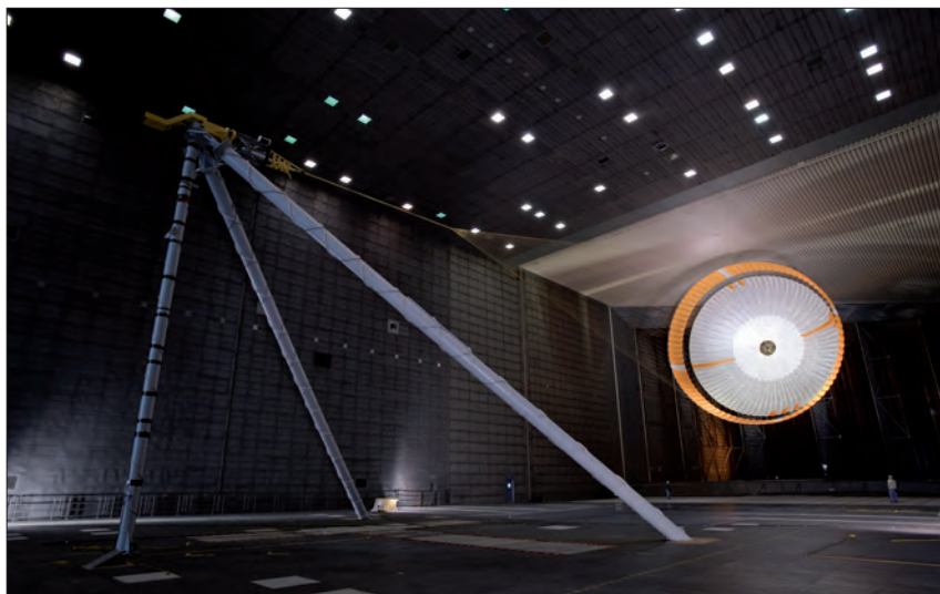
Ensayo del paracaídas de frenado.
