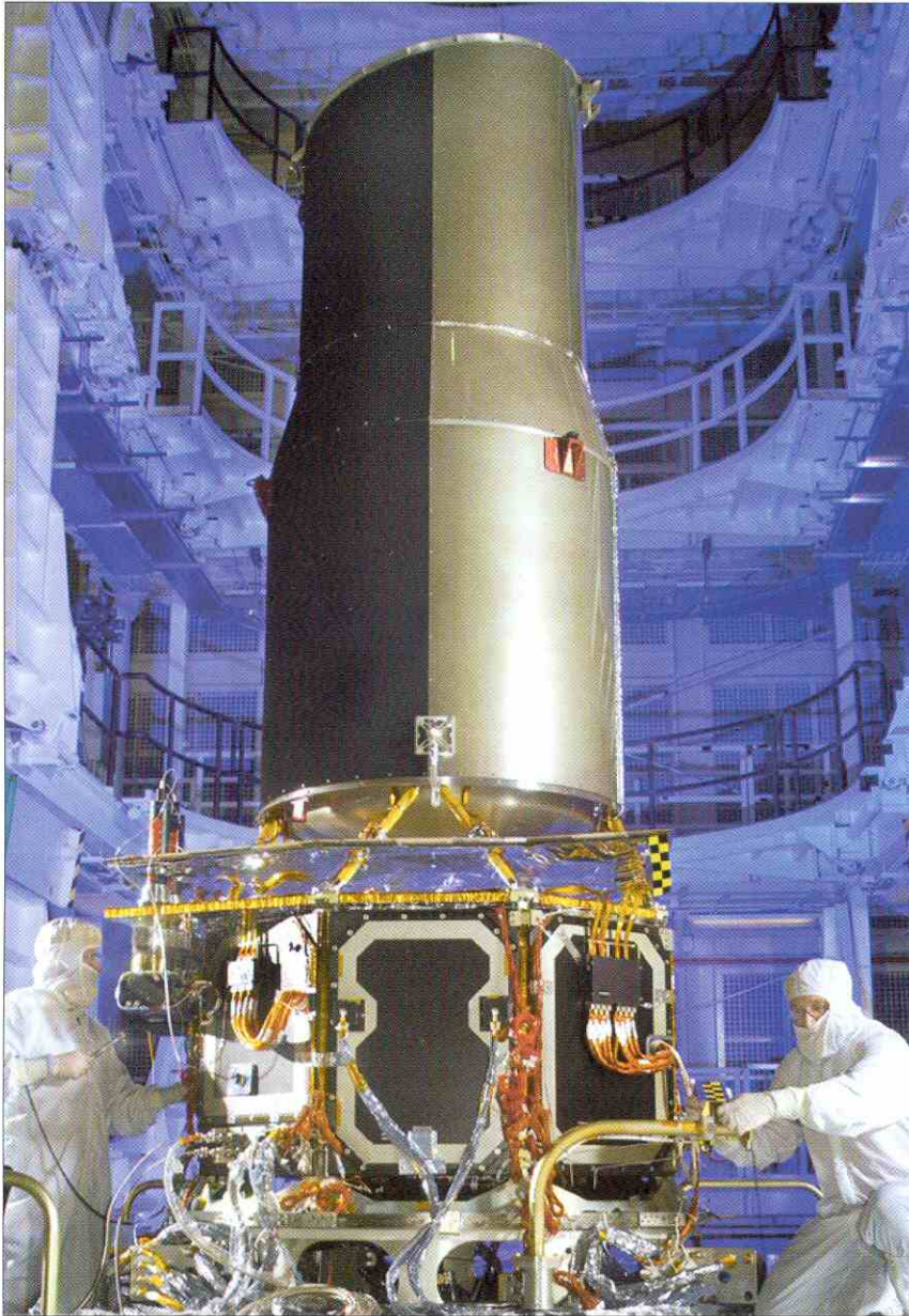
El SIRTf en construcción. (Foto: Lockheed Martin.)
