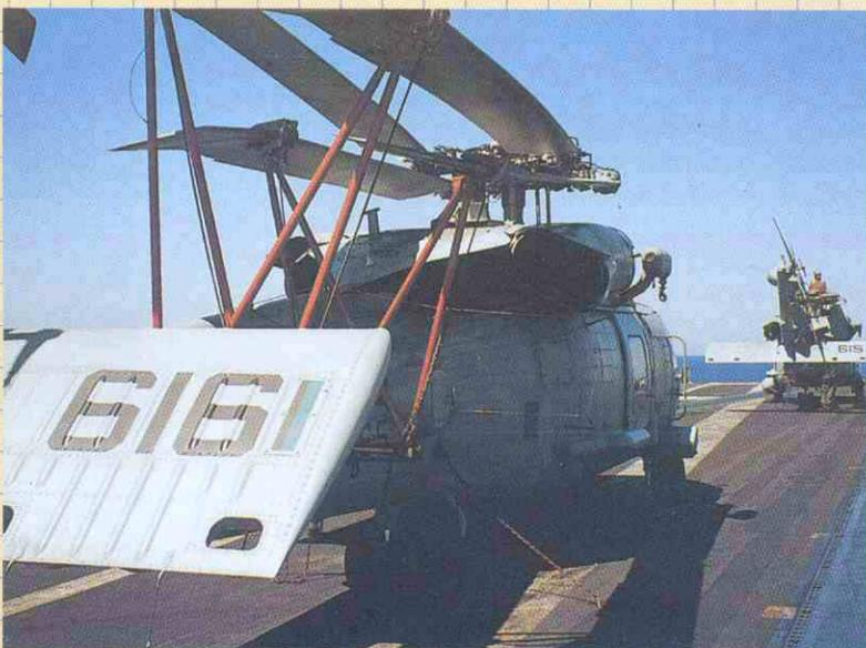
*Para los helicópteros CSAR es muy deseable la capacidad de aerotransporte y/o embarque, lo que incluye, entre otras cosas, la posibilidad del plegado de palas.*
