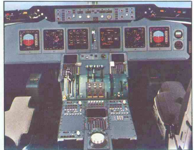
En el trirreactor comercial de McDonnell Douglas MD-11, comenzó a montarse el "cockpit" el 9 de marzo de 1988. Como puede observarse en la fotografía, toda la instrumentación es por pantallas CRT (Cathode Ray Tube). (Fig. 14).
