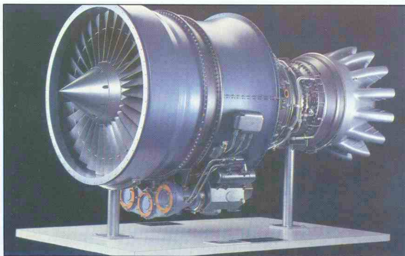
La Compañía CFE creada el año 1987 entre Garret y Allied Signal ha dedicado todo el año 88 a la producción de su primer motor, el CFE 738, de 5.300 libras de empuje e índice de derivación 5,3/1. Es un motor idóneo para aviones tipo "commuter" regionales. Este primer motor comenzará su programa de pruebas a principios de 1989. (Fig. 17).
