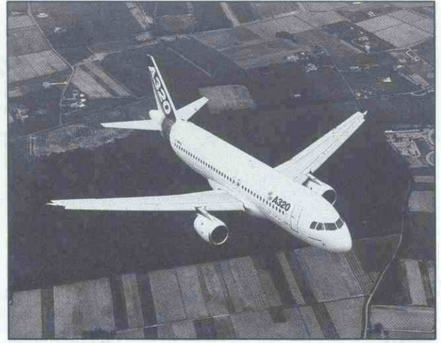
El A320 de Airbus Industrie entró en servicio en la primavera de 1988, propulsado por motores CFM 56-5. Los vuelos de prueba con motores V-2500 de IAE, acaban de comenzar. (Fig. 12).
