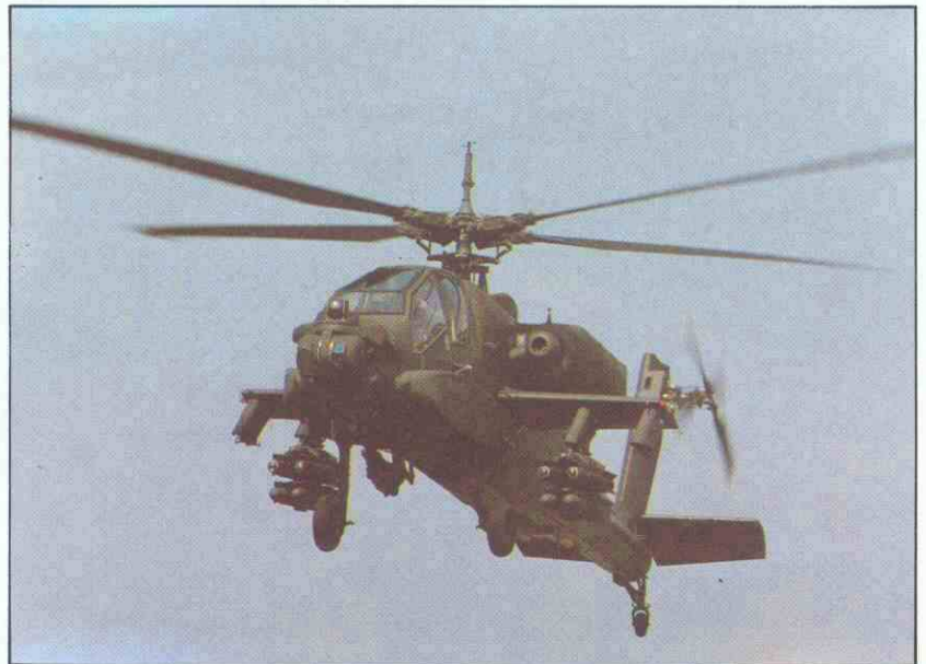
El helicóptero McDonnell Douglas AH 64A "Apache" que se ha comenzado en 1988 a dotarle del sistema Martin Marietta TADS/PNVS (Target Acquisition Designation Sight/Pilot Night Vision Sensor), con el que podrá volarse de noche y en condiciones climáticas adversas. (Fig. 3).
