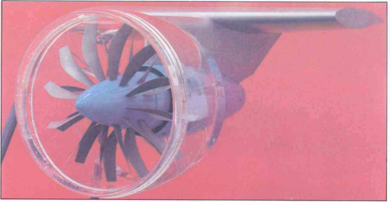
El CRISP (Counter Rotating Integrated Shorouded Propfan) que durante 1988 ha recibido un fuerte impulso como competidor de los Propfan y Unducted Fan, actualmente ya en pruebas en vuelo. Lo fabricará MTV de Munich. (Fig. 20).
