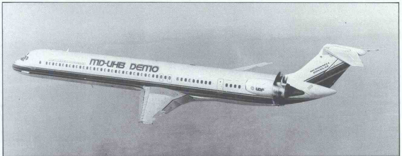
Durante 1988 se han estado haciendo pruebas del motor UDF (Un Ducted Fan) de General Electric, situado en la posición izquierda de un MD-81. Las pruebas, en posición número tres, sobre un B-727, se realizaron en 1987. (Fig. 15).
