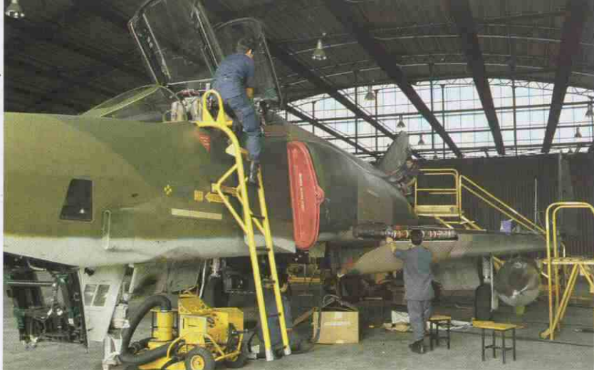
El Mamat debe atender 28 tipos distintos de aviones; en la foto un CR-12 (RF-4C) en los talleres del segundo escalón de mantenimiento.
