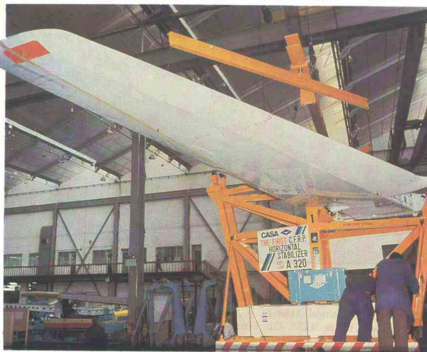
Estabilizador del A-320 en fibra de carbono.
