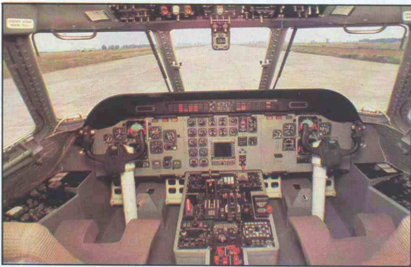
Cabina de pilotaje del CN-235 M. El sistema EFIS puede ofrecerse como opción.
