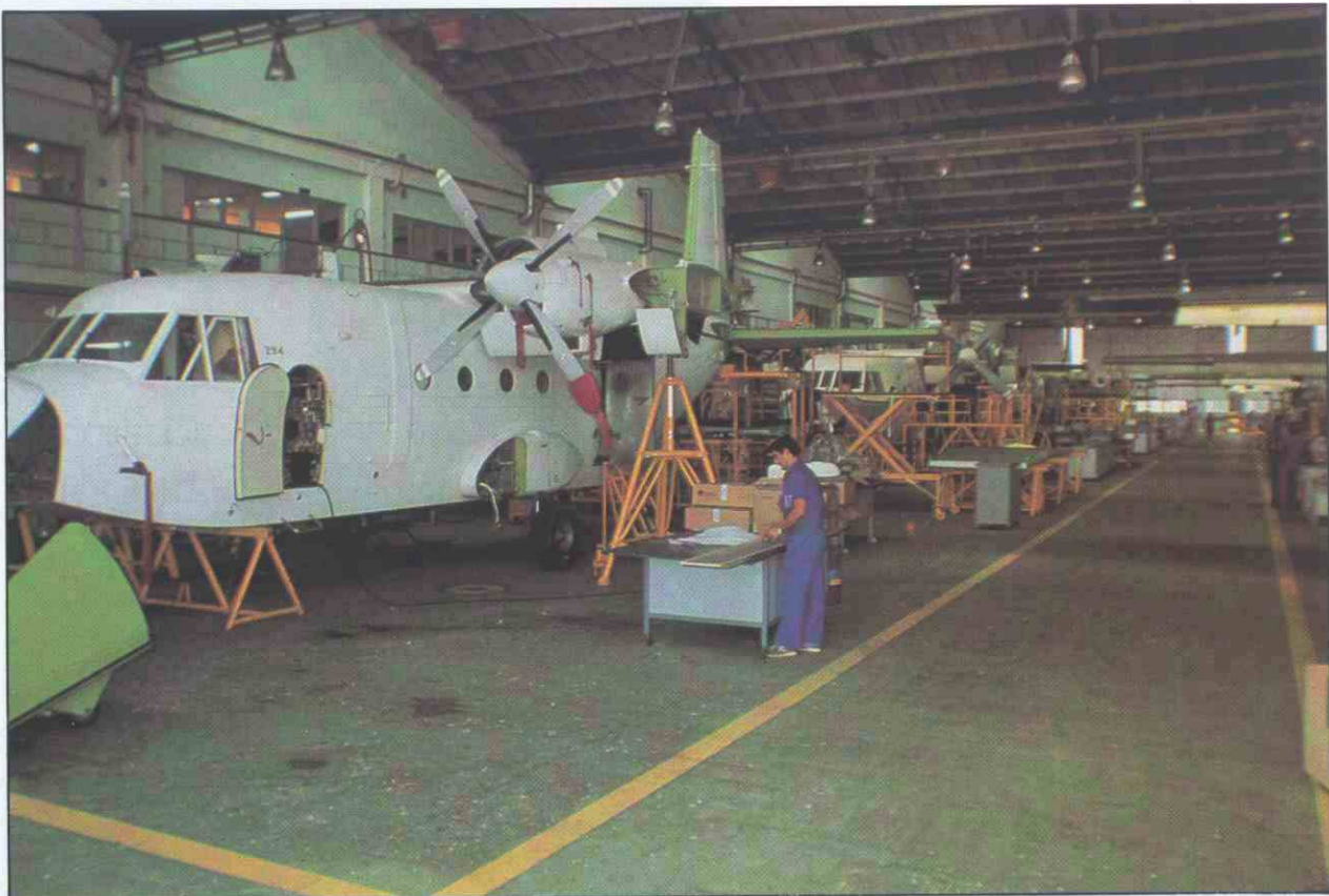
Línea de montaje final del C.212 "Aviocar" en la Factoría de San Pablo de CASA.
