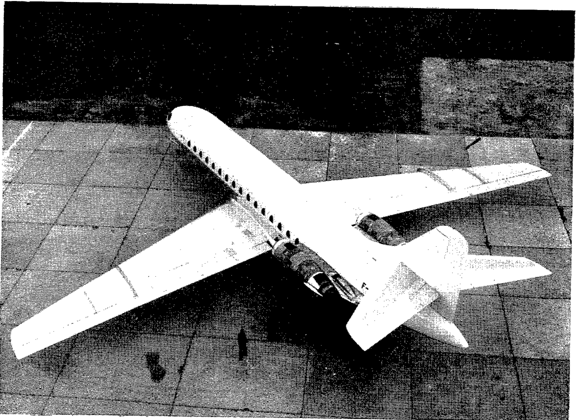
La fotografía, hecha en el aeródromo Toulouse-Blagnac, nos presenta al nuevo "Caravelle 10 R", que ya ha entrado en servicio en varios países. Este nuevo modelo está equipado con reactores de doble flujo Pratt and Whitney, que le permiten aumentar su autonomía.
