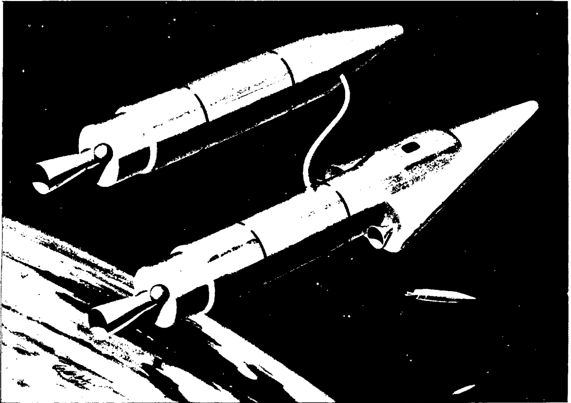
Dibujo de un vehículo interplanetario en el momento de ser abastecido de combustible por otro vehículo puesto previamente en órbita. Por este procedimiento planeado por Lockheed, se consiguen evitar los enormes pesos alcanzados por las naves espaciales, en el momento del lanzamiento.
