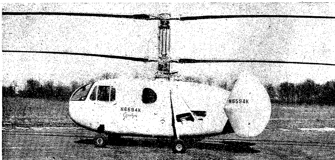
Helicóptero Gyrodine 2c, con las modificaciones introducidas con relación a la versión anterior: fuselaje alargado, mayor distancia entre rótores y tren de aterrizaje perfeccionado.
