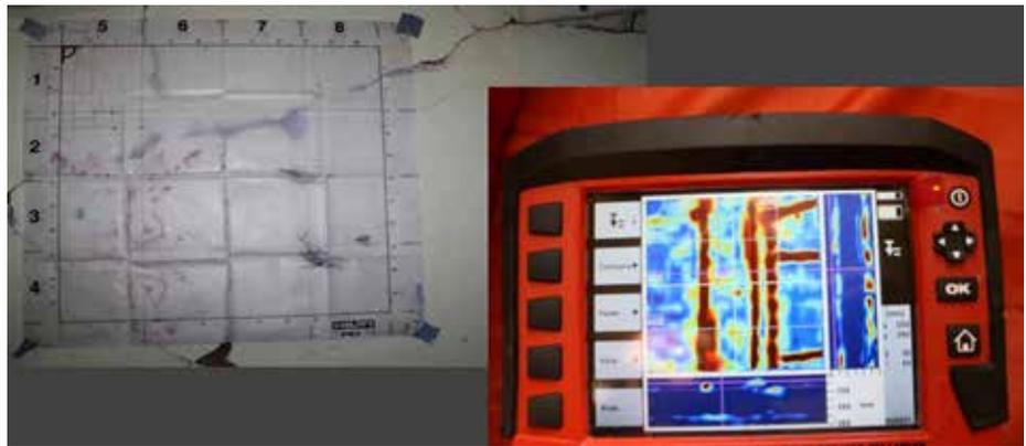
*Equipo portátil de diagnóstico de armadura de hormigón armado*
