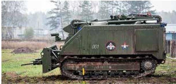
*“Unmanned Ground Vehicle” (UGV) multipropósito ruso “URAN-14”, capaz de reconocer y abrir brechas en áreas minadas*
