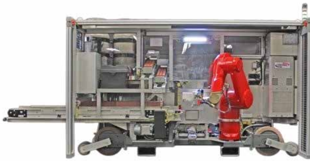
Robot de construcción de tabiquería de ladrillo "Semi-Automated Mason" (SAM100)
