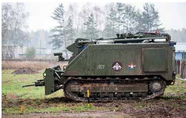
“Unmanned Ground Vehicle” (UGV) multipropósito ruso “URAN-14”, capaz de reconocer y abrir brechas en áreas minadas
