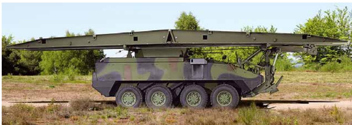
Vehículo Lanza Puentes (VLP) sobre barcaza "Piranha"
