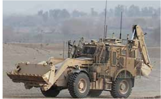
Retroexcavadora JCB “High Mobility Engineer Excavator” (HMEE) estadounidense
