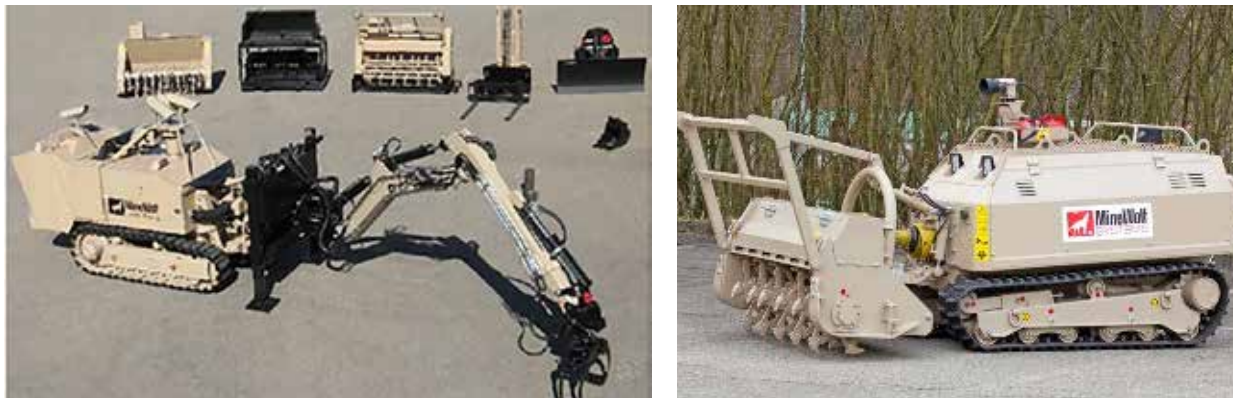
Vehículo teledirigido de limpieza de rutas "Micro Mine Wolf MW 50" con sus implementos
