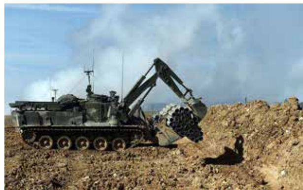
“Combat Engineering Vehicle” (CEV) “TERRIER” británico teledirigido colocando fajas en un foso contracarro en un ejercicio (06/04/2018)
