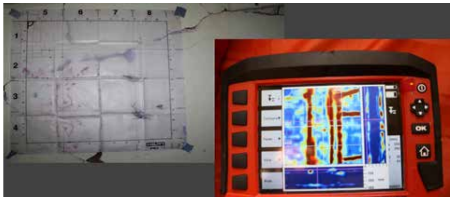
Equipo portátil de diagnosis de armadura de hormigón armado
