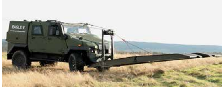
Vehículo protegido ligero “EAGLE V”, de la empresa MOWAG, tendiendo un puente de apoyo a fuerzas ligeras
