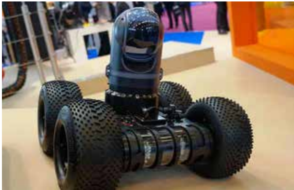
Robots teleoperados terrestre “Mini Robot Génie” (MiniRoGen) y aéreo “Dron Génie” (DroGen) de los Ingenieros franceses
