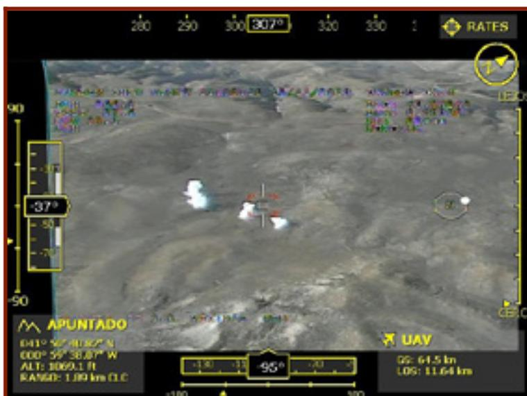
Figura 13: imagen del centro de impactos observado por la cámara del RPAS ATLANTIC sobre la zona de caída de proyectiles del Puig Amarillo en el CENAD de San Gregorio. Las del CDI obtenidas por la imagen del *guimbal* aparecen en geográficas mientras que la GCS las transforma en cartesianas UTM en los datos de telemetría, que son las que habitualmente se usan para realizar correcciones
