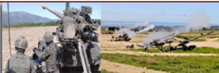
Figura 2: batería de obuses SIAC de 155mm pertenecientes al RALCA 63, haciendo fuego en el CENAD de San Gregorio (Zaragoza). En la imagen de la izquierda se puede observar al Jefe de pieza comprobando y validando la orden de fuego generada en el FDC de la sección y que llega hasta el computador TALOS de la pieza vía radio
