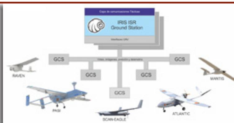
Figura 11: entorno interfaz RPAS IRIS. Cuando se encuentran varios sistemas diferentes operando en una o varias zonas, cada GCS lleva asociada una interfaz IRIS cliente o ISR que permite interactuar con el CSD a través de una única interfaz IRIS servidor RPAZ tal y como se expone en la figura 10
