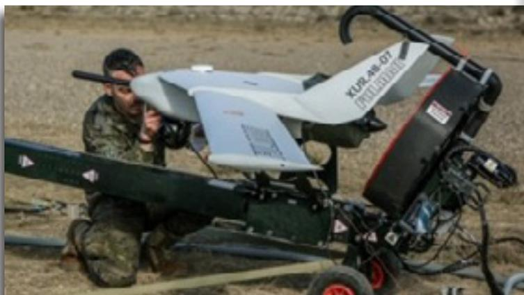
Figura 9: personal de la unidad RPAS FULMAR realizando el test de vuelo previo a su lanzamiento para una operación
