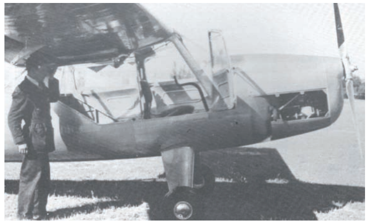
Fotografía del prototipo del AVD-12 en la que puede apreciarse la gran accesibilidad de la cabina y el elevado nivel de visibilidad.
