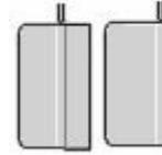
**Timón compensado:** cuando la pala está a ambas partes del eje.
