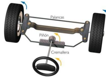
Fig 40: Sistema dirección automóvil.
