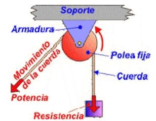
Fig19: Polea fija
