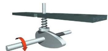
46. Identifica los diferentes mecanismos que aparecen en la figura e indica hacia donde se moverá la luna al girar la manivela en el sentido indicado.
