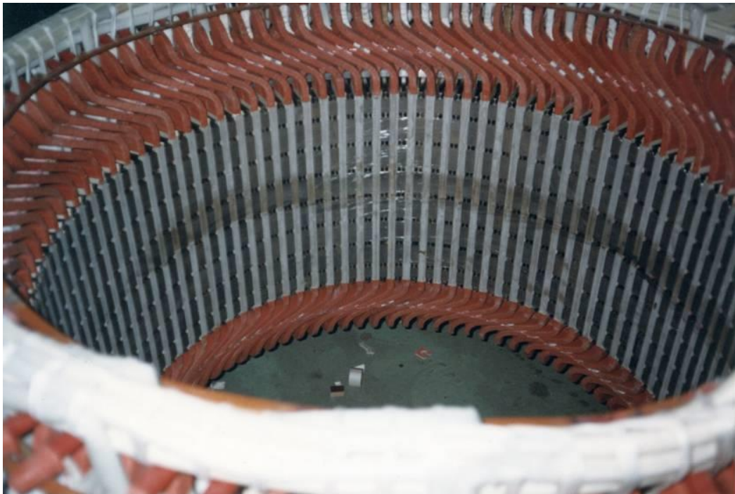
Fig. 2: Estator de un alternador trifásico
