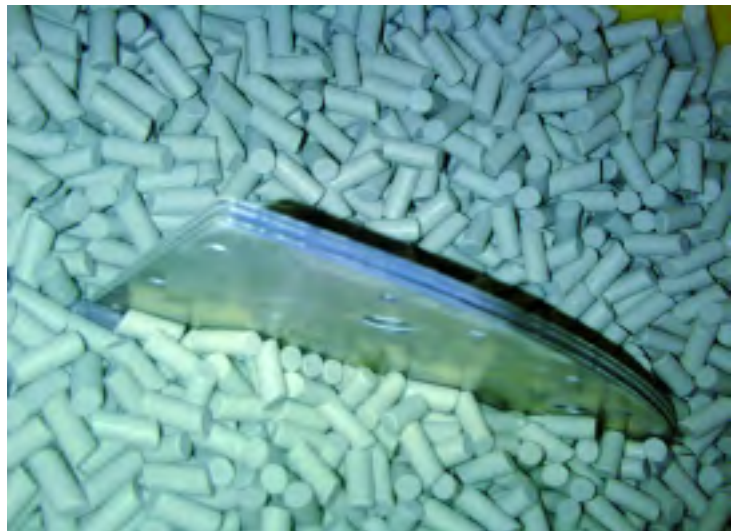
Ejemplo de tres piezas totalmente pegadas durante el proceso de vibración.
