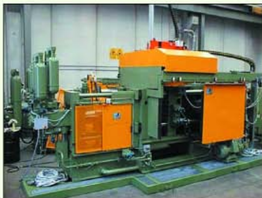
Máquina de cámara fría de 400 Ton de fuerza de cierre
