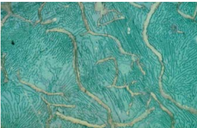
Fundición gris perlítica. Reactivo Beraha. Esta fundición contiene algo de cobre para que sea completamente perlítica.
