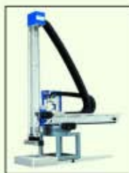
Pulverizador de desmoldeante, dos ejes controlados
