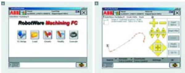
La interfaz gráfica de usuario tal como se presenta en el Flex-Pendant. El recorrido se presenta en vista tridimensional para facilitar el examen y la modificación.
