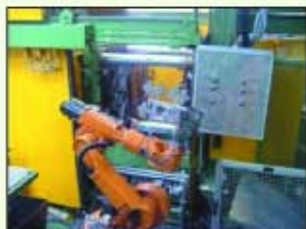
Robot KUKA en célula de fundición automatizada
