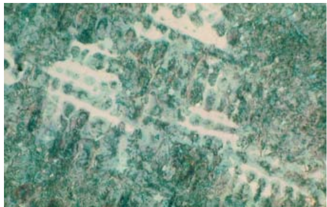
Fundición gris perlítica. Reactivo Beraha. Dendritas de austenita primaria en una fundición eutéctica.
