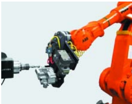
Robot con sensor, soporte y mandril estacionario para desbarbado flex.
