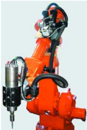
Robot con paquete Force Control Function (función de control de fuerza).
